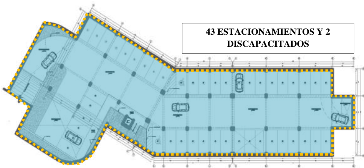
Figura 54: Planta de distribución sótano
