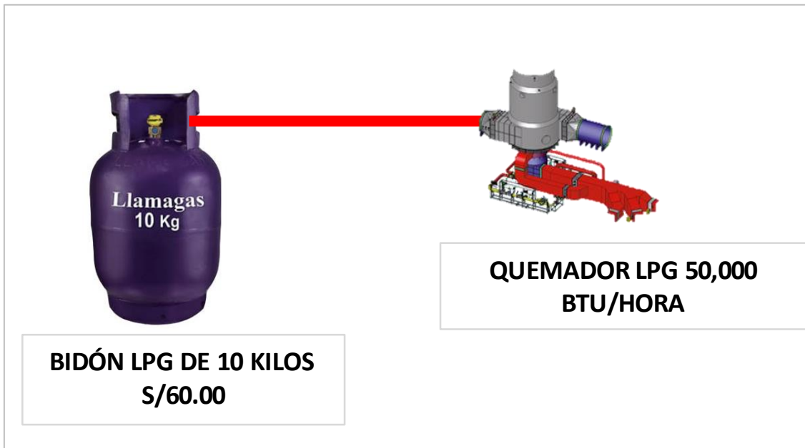
Figura 17. Instalación actual de LPG
