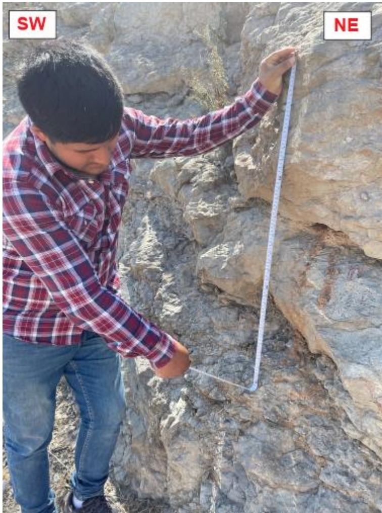
Figura 22 Toma de datos relacionado al espesor real del estrato de caliza obtenido de forma perpendicular a la estratificación.
