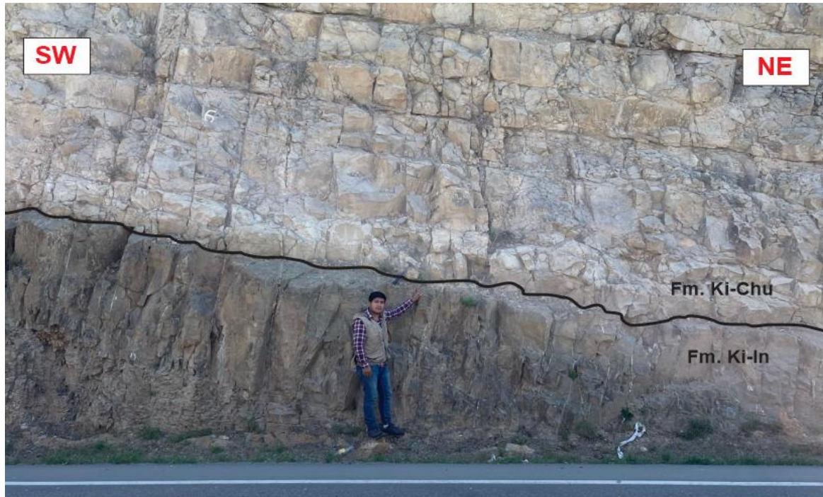
Figura 8 Contacto de la formación Chúlec y la formación Inca Inca donde la diferencia de color nos muestra el cambio litológico y en este caso el contacto entre formaciones geológicas
