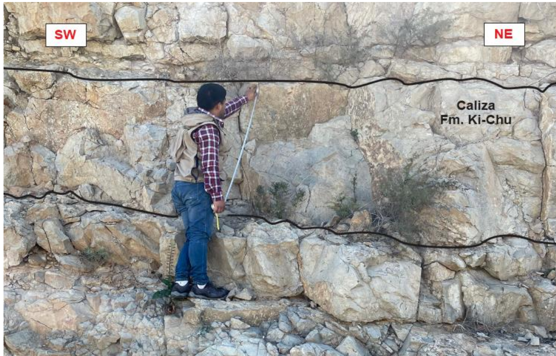
Figura 11 Caliza de la formación Chúlec, donde se media el espesor real de la sedimentación medido de forma perpendicular a la estratificación.
