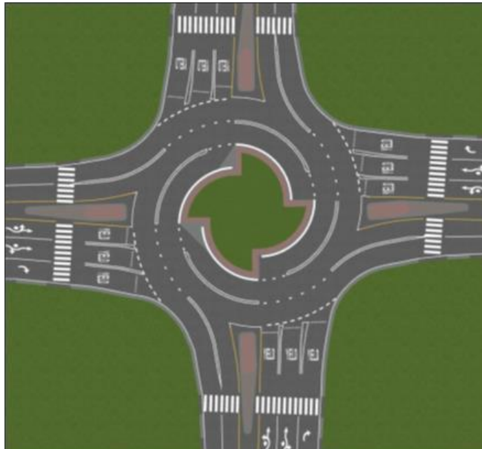
Figura 11. Ejemplo de turbo rotonda tipo rotor Fuente: Wankogere, E. (2014). Virtual analysis and evaluation of roundabout safety and operational features.
