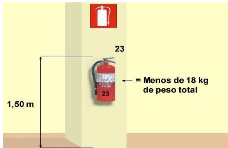
Figura 49: Instalación de extintores.
