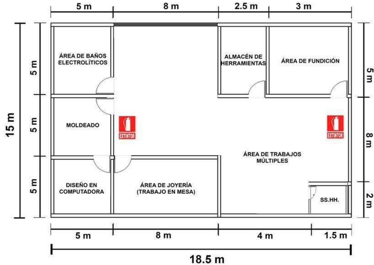
Figura 51 : Ubicación de extintores.
