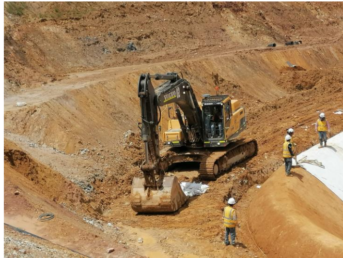
Figura I: Excavadora 380DL propiedad de la contratista CEDAR en la mina el SUMMA GOLD CORPERATION – cucharón: 2.6m 3
