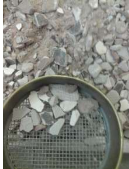
Figura 49: Trituración y selección del porcelanato reciclado triturado
