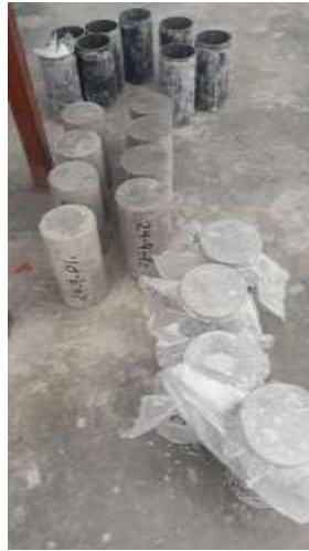
Figura 55: Desmolde y codificación de probetas cilíndricas.
