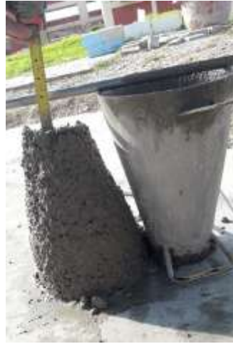
Figura 52: Concreto reemplazando agregado fino por porcelanato reciclado
