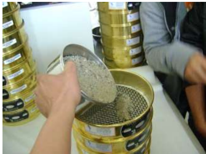
Figura 50: Análisis granulométrico del agregado y porcelanato reciclado
