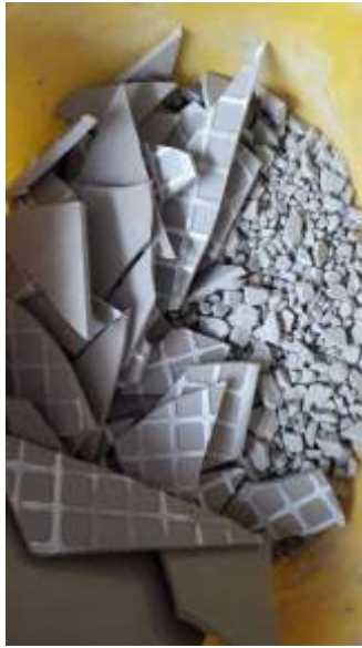
Figura 49: Trituración y selección del porcelanato reciclado triturado
