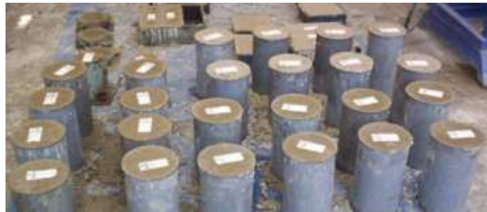
Figura 54: Elaboración de probetas cilíndricas de 10 cm x 20 cm
