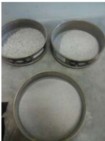
Figura 50: Análisis granulométrico del agregado y porcelanato reciclado
