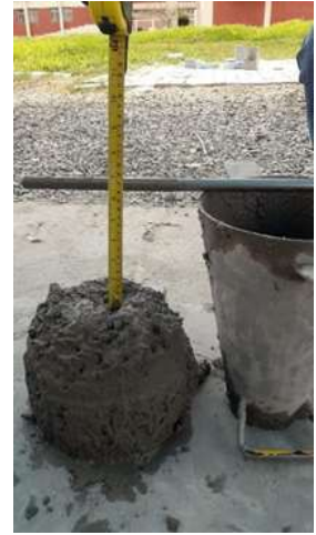
Figura 53: Concreto reemplazando agregado grueso por porcelanato triturado
