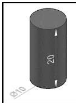
Figura 6: Dimensiones de las probetas cilíndricas
