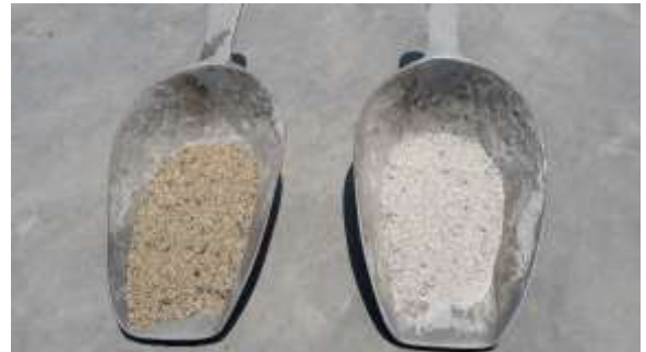
Figura 48: Molienda y obtención del porcelanato reciclado molido
