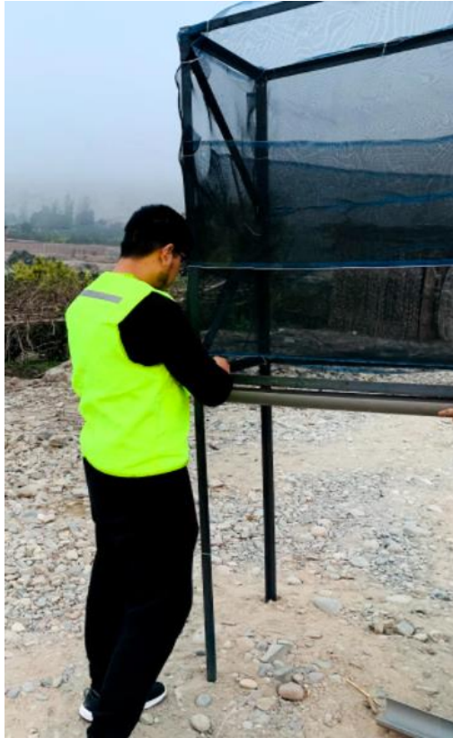
Figura 56. Instalación del sistema de drenaje del captador de diseño prismático optimizado.
