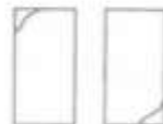
Tipo 5 Fracturas en sus lados en las partes superior e inferior (ocurre comúnmente con cabezales no adheridos)
