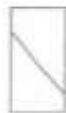
Tipo 4 Fractura diagonal con fisuras a través de los extremos, golpeado suavemente con un martillo para distinguir del Tipo 1
