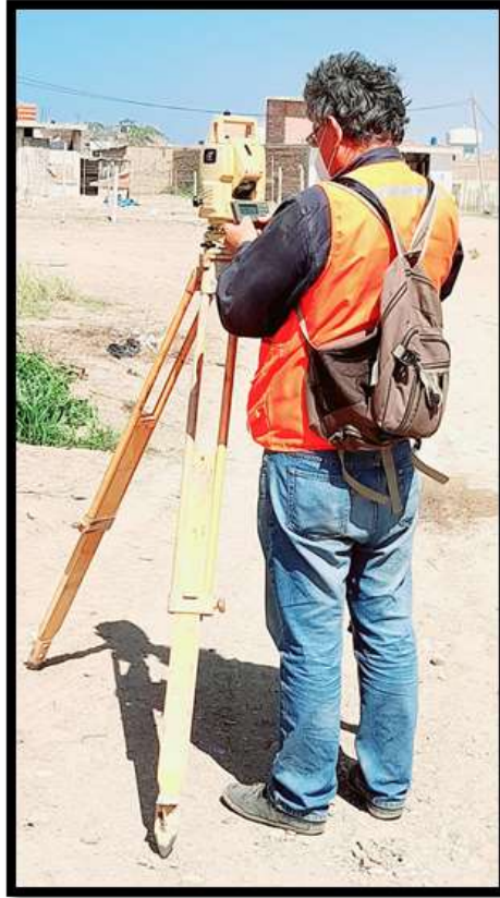
TOMA 05: En esta toma se aprecia al topógrafo tomando los datos y digitalizándolos en la Estación Total - Levantamiento Planimétrico
