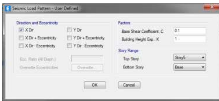
Figura 30 Cuadro de patrón de cargas sísmica en la dirección X en el programa ETABS
