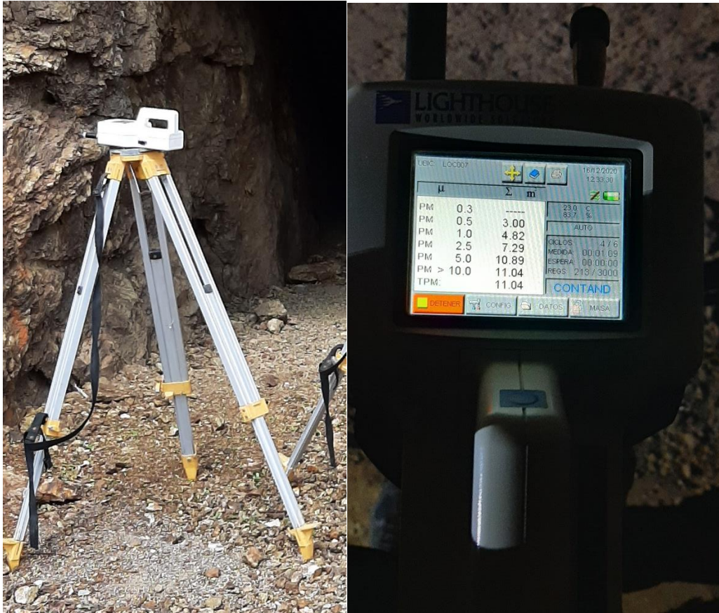
Figura 6. Contador de partículas HANDHELD 3016 (0.5 y 10 \mu m) con un flujo de 0.1 CFM.
