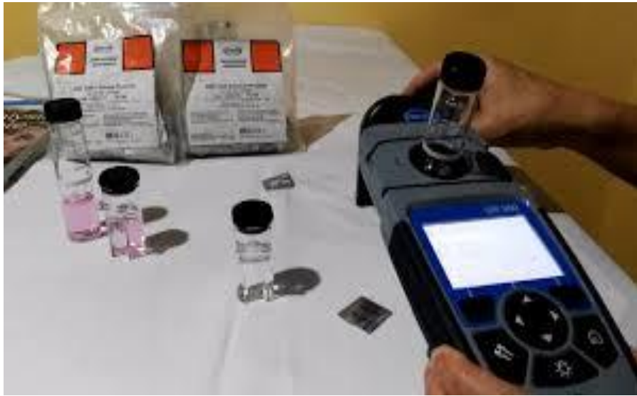
Foto 4: Medición de cloro libre y total con el equipo HACH DR 1900
