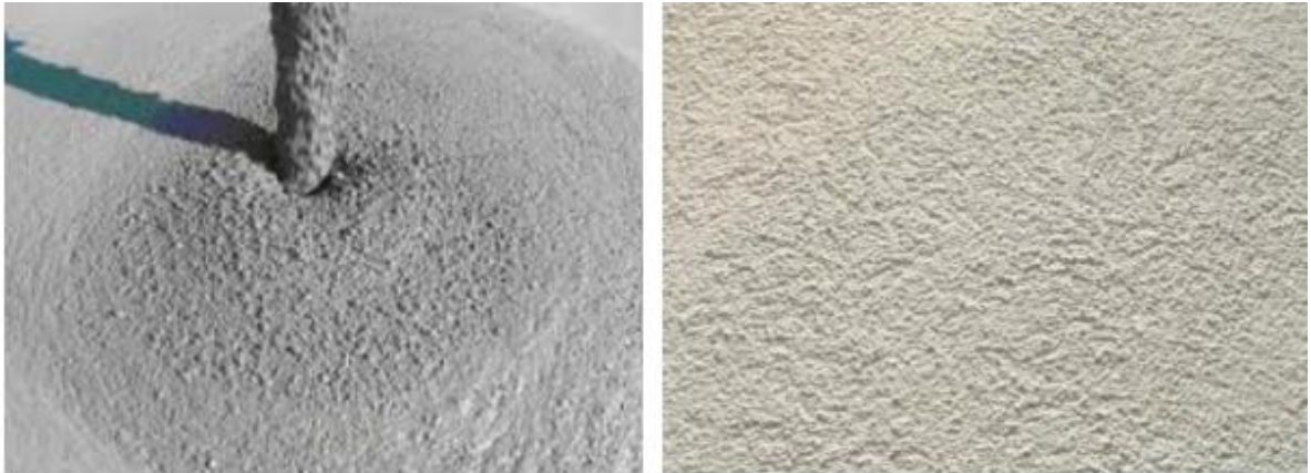
Figura 4. Muestra de concreto antes y después de fraguado
