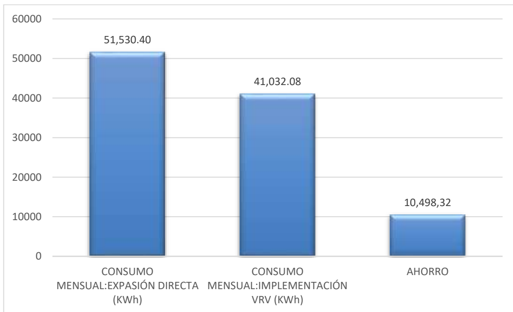
Figura 47. Ahorro del Consumo eléctrico mensual por sistema de expansión versus implementación de VRV.
