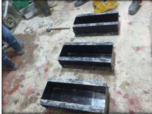
*Figura 14.* Encofrado de Acero
