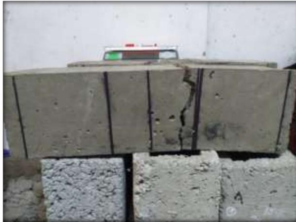
Figura 39. Falla de Viga Monolítica M1
