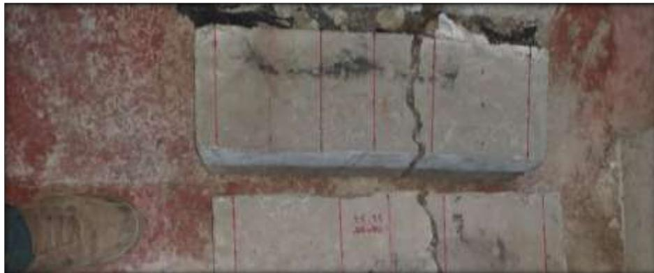
Figura 49. Falla de Viga Monolítica M3
