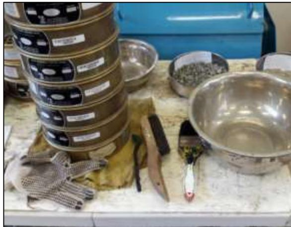
**Foto N° 06:** En la fotografía se observa los instrumentos para el tamizado.
