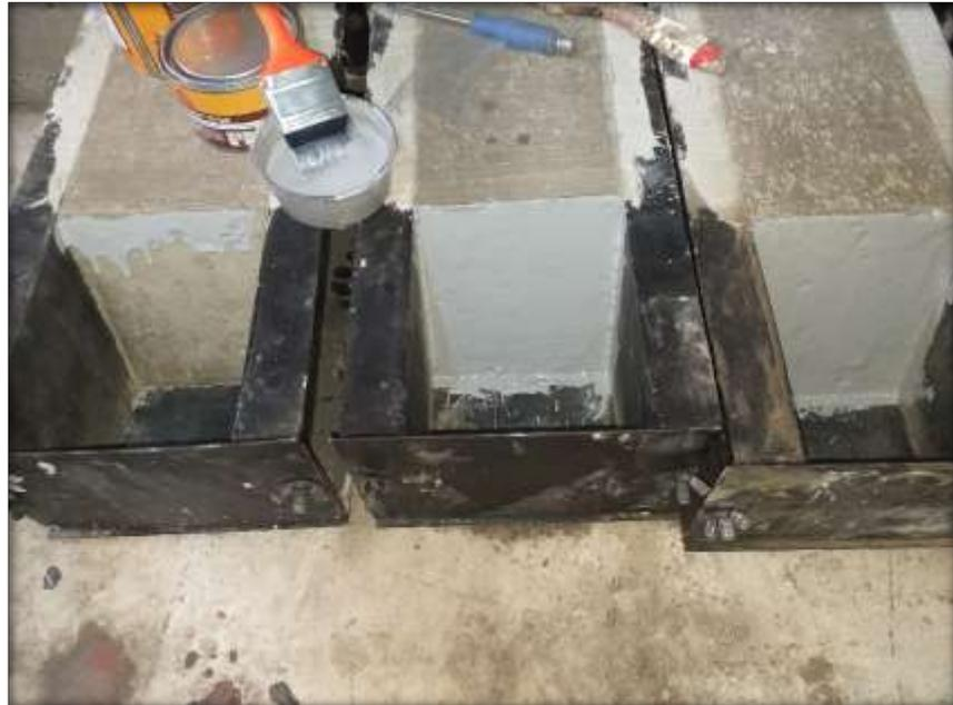
*Figura 21.* Aplicación de Sika Dur 32 Gel en las Vigas M7, M8 y M9
