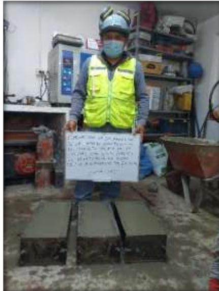
*Figura 16.* Viga M1, M2 y M3 Vaciados Monolíticamente
