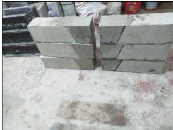
**Foto N° 13:** En la fotografía se observa la junta de construcción con y sin puente de adherencia en las vigas
