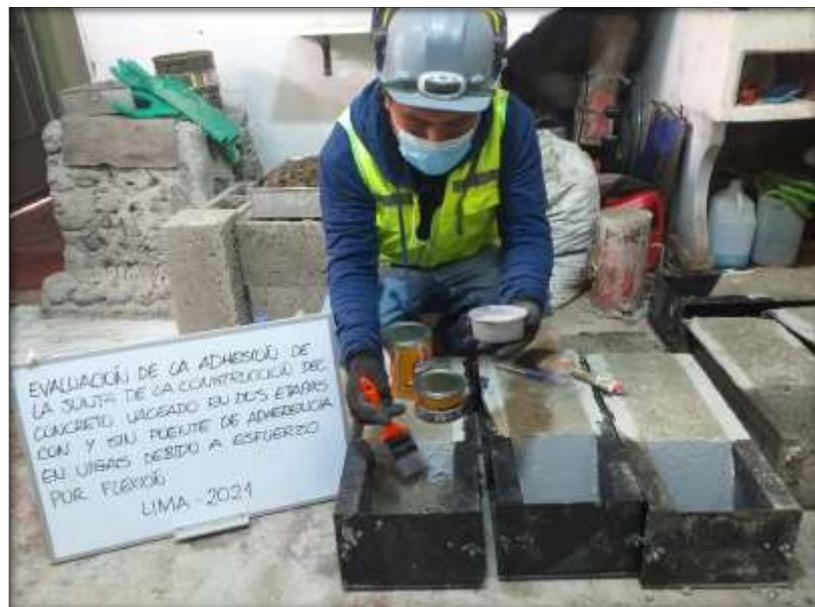
*Figura 22.* Aplicación del Puente de Adherencia
