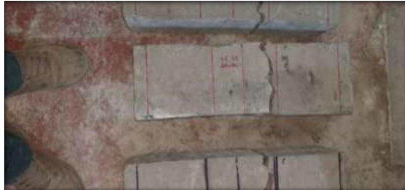
Figura 44. Falla de Viga Monolítica M2
