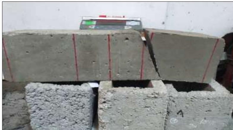
*Figura 59. Falla de Viga M5*
