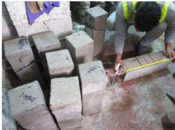
**Foto N° 16:** En la fotografía se observa la demarcación de los especímenes antes de ser ensayados.
