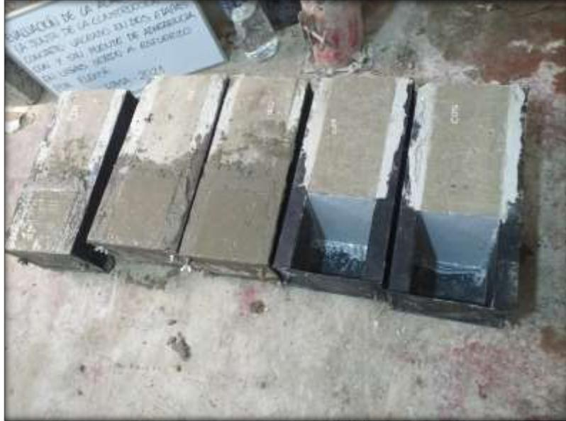
*Figura 23.* Vaciado de Concreto Faltante en las Vigas M4 al M9
