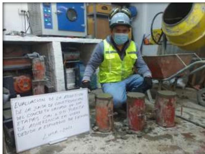
Figura 26. Probetas de Concreto Segundo día de Vaciado
