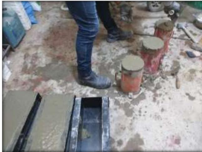
*Figura 20.* Probetas de Concreto Primer día de Vaciado
