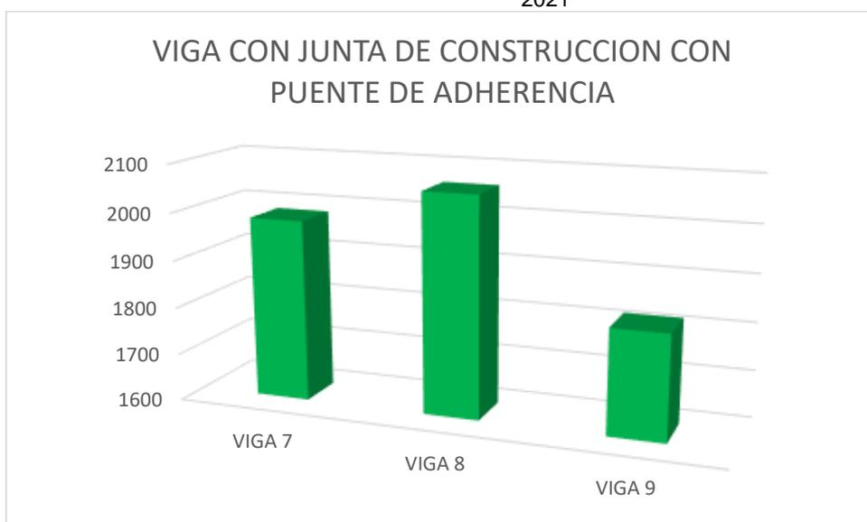
Figura 87. Cuadro Comparativo de Resistencia a la Flexión de Vigas con Junta de construcción con Puente de Adherencia.
