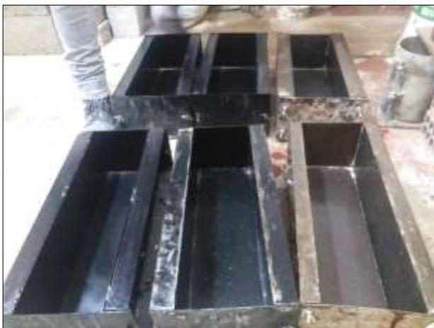
*Figura 13.* Encofrado Metálico
