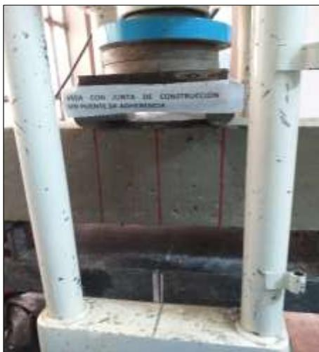
Figura 61. Viga en Máquina de Carga
