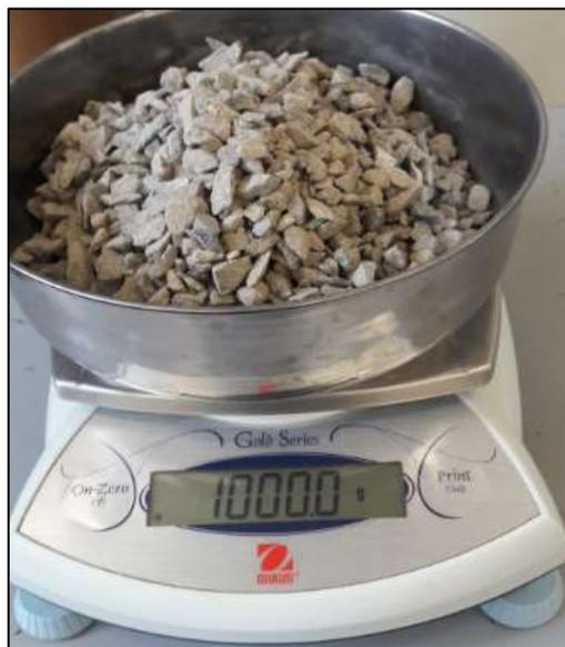
***Foto N° 02:*** En la fotografía se observa el pesaje de los materiales a ensayar.
