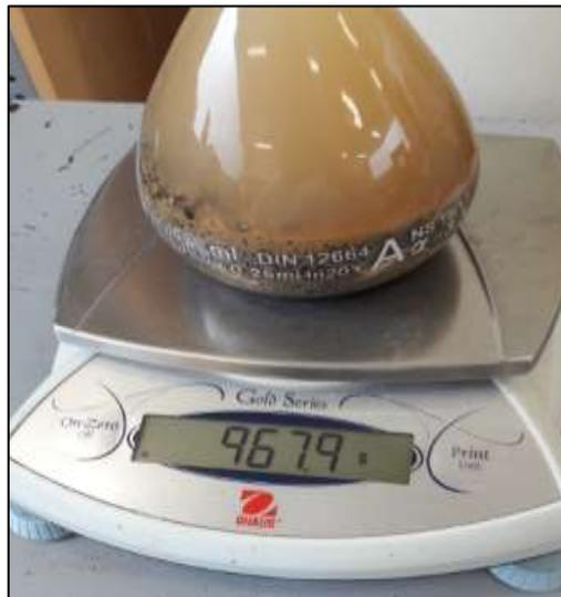
**Foto N° 09:** En la fotografía se observa el proceso de gravedad específica.
