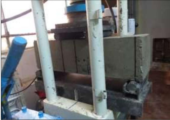
*Figura 36.* Viga a ser Ensayada en Maquina de Cargas
