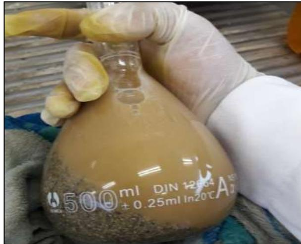
**Foto N° 08:** En la fotografía se observa el proceso de la gravedad específica.
