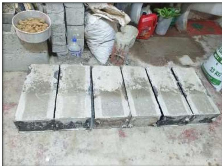
*Figura 28. Vistas de las 6 Vigas con Junta de Construcción*
