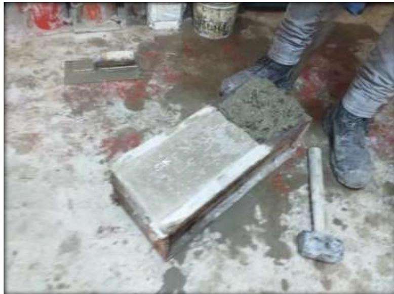
*Figura 24.* Viga M4 Sin Puente de Adherencia
