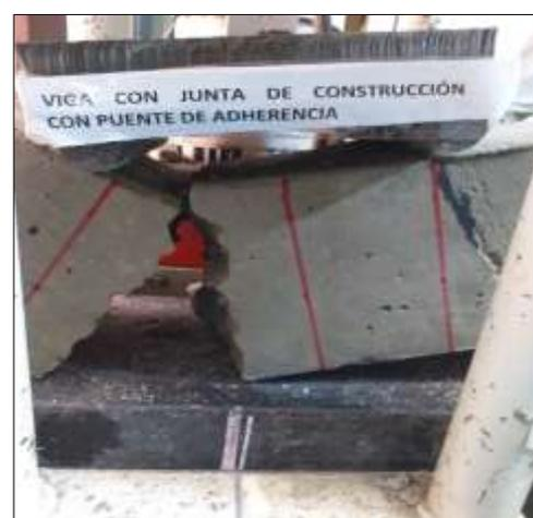
Figura 71. Ensayo de Viga
