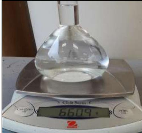
**Foto N° 10:** En la fotografía se observa el proceso de gravedad específica.
