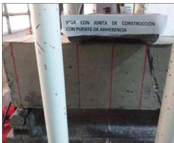
Figura 72. Viga en Máquina de Carga
