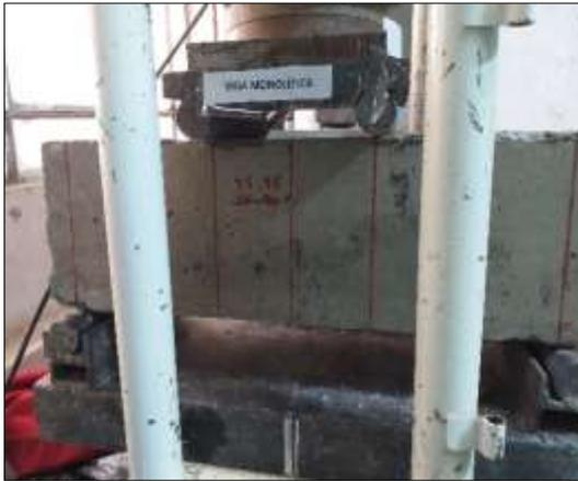
*Figura 41. Viga en Máquina de Carga*
