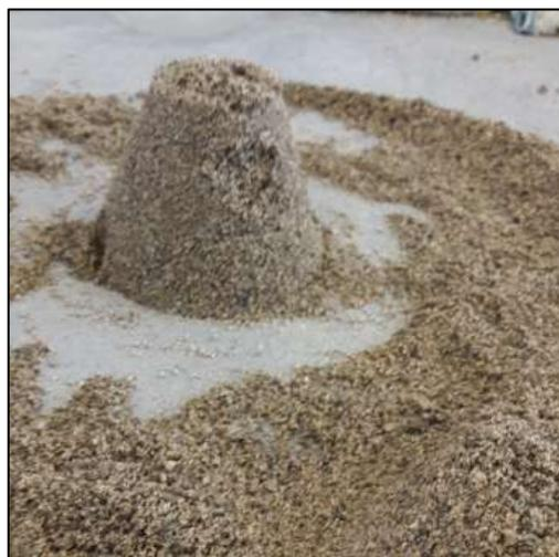
**Foto N° 07:** En la fotografía se observa el proceso de gravedad específica.
