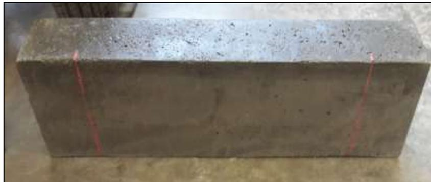
**Foto N° 15:** En la fotografía se observa la viga M1 retirado de la poza de curado después de 7 días de curado.
