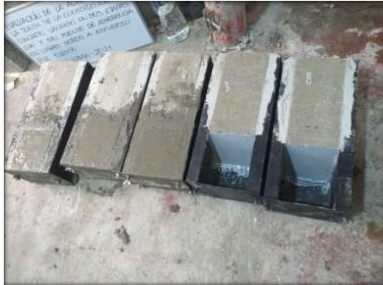
Figura 25. Vaciado de Concreto Faltante en las Vigas M4, M5 y M6
