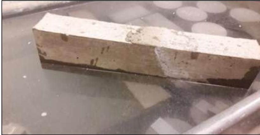
**Foto N° 14:** En la fotografía se observa el proceso de curado de los especímenes.
