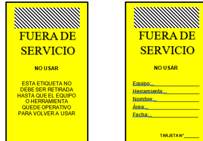
Fig.3. Tarjeta amarilla de identificación de equipos o herramientas inseguras Elaboración Propia Minitab 2019.
