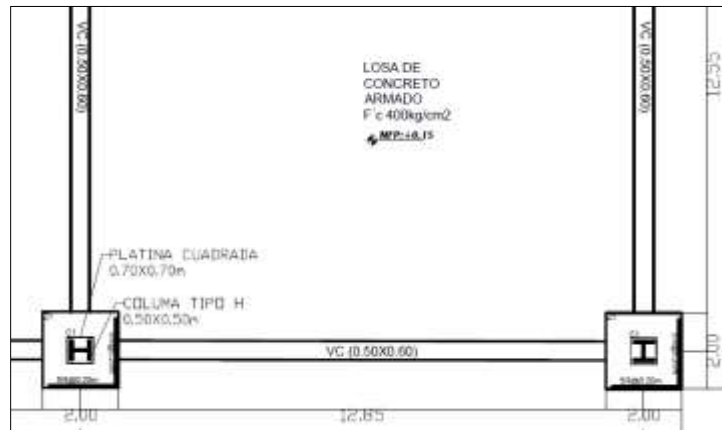
Figura 78. Vista de plano de cimentación
