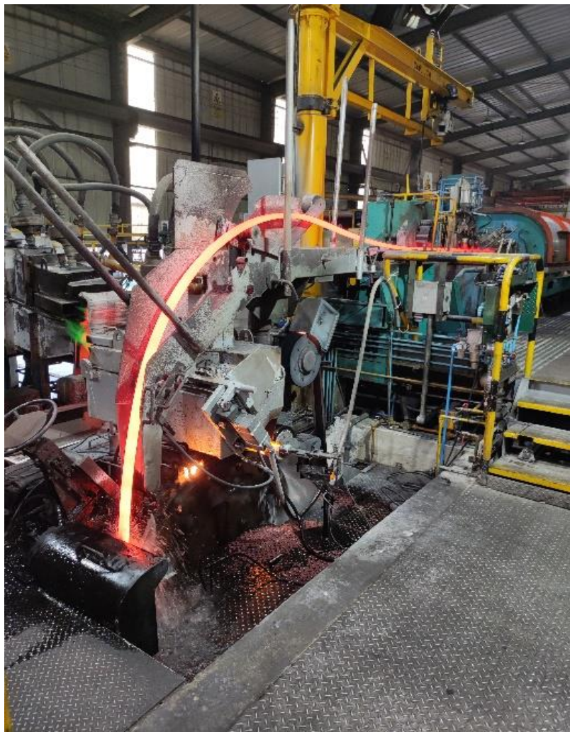
Figura14. Cobre solidificado saliendo del recipiente tundish
