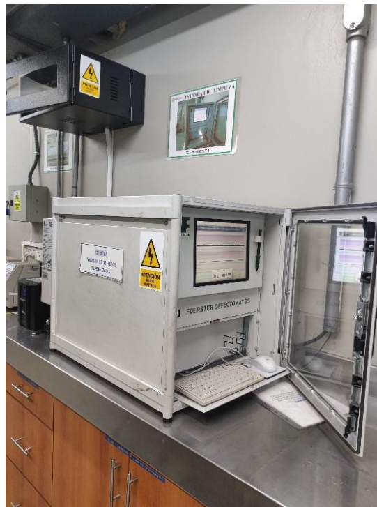
Figura28. Equipo medidor de aspecto superficiales (FOERSTER)
