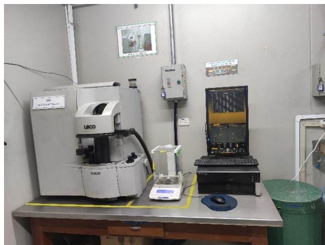
Figura22. Equipo medidor de oxígeno (LECO)
