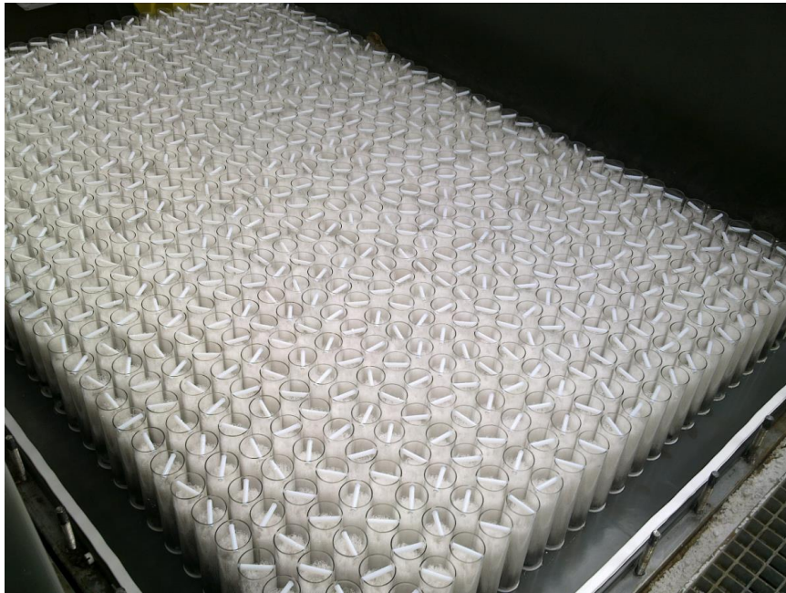
Figura 4. Disposición de los tubos de vidrio en el interior del condensador. Fuente: Introducción a la tecnología WSA de Topsoe.
