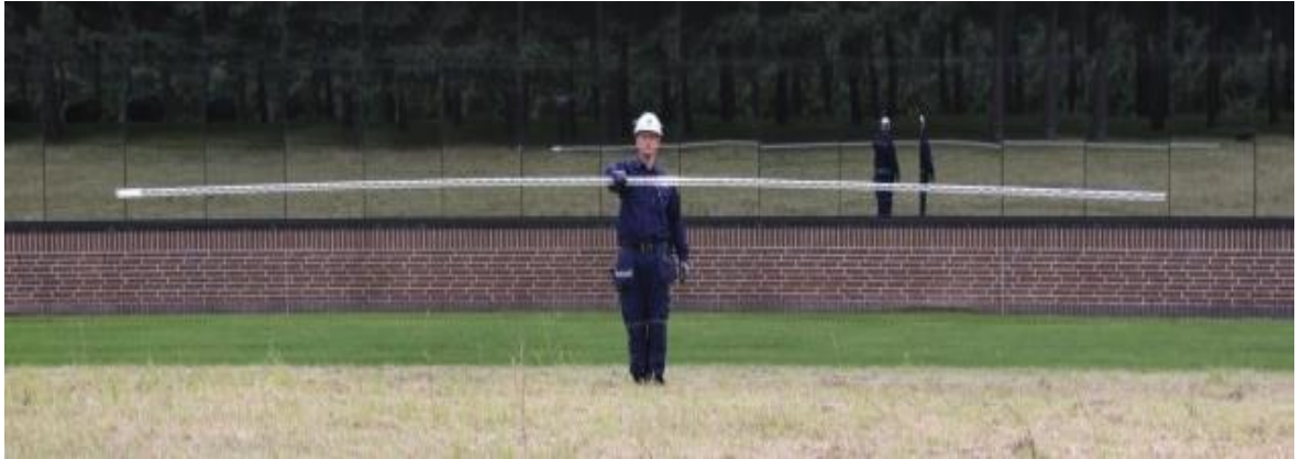
Figura 5. Tubería de vidrio de borosilicato. Fuente: Introducción a la tecnología WSA de Topsoe
