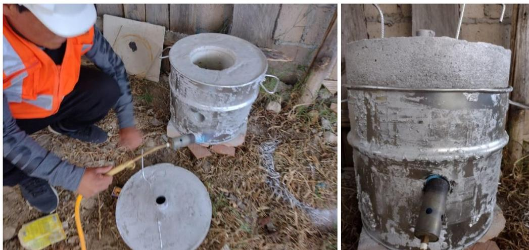
*Ilustración 19: Construcción del horno para la fusión de concentrados de oro, se puede apreciar el orificio por donde se inyecta el calor.*
