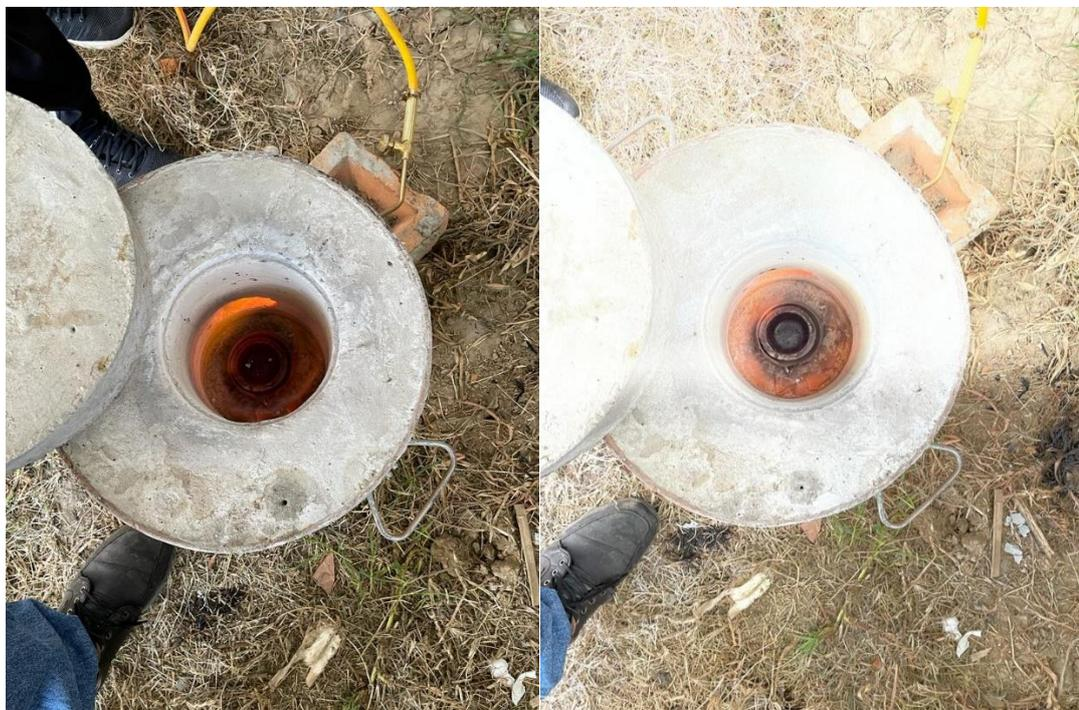
Ilustración 20: Operación de horno donde se puede notar el ingreso de la llama de manera tangencial.
