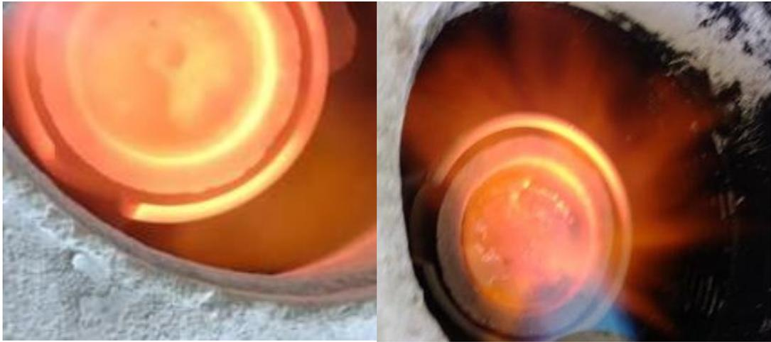
*Ilustración 21: Horno en operación donde se puede apreciar el material fundido.*
