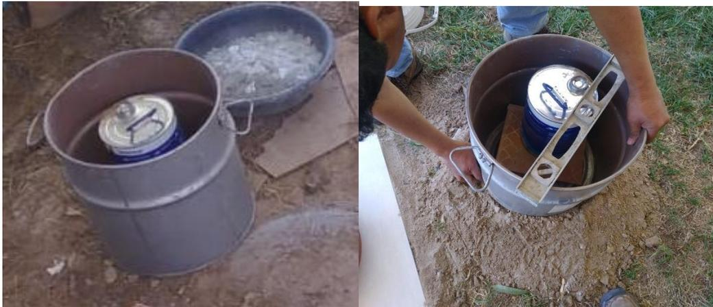
*Ilustración 15: Construcción del horno para la fusión de concentrados de oro, se puede apreciar el vidrio molido y los materiales para la construcción.*
