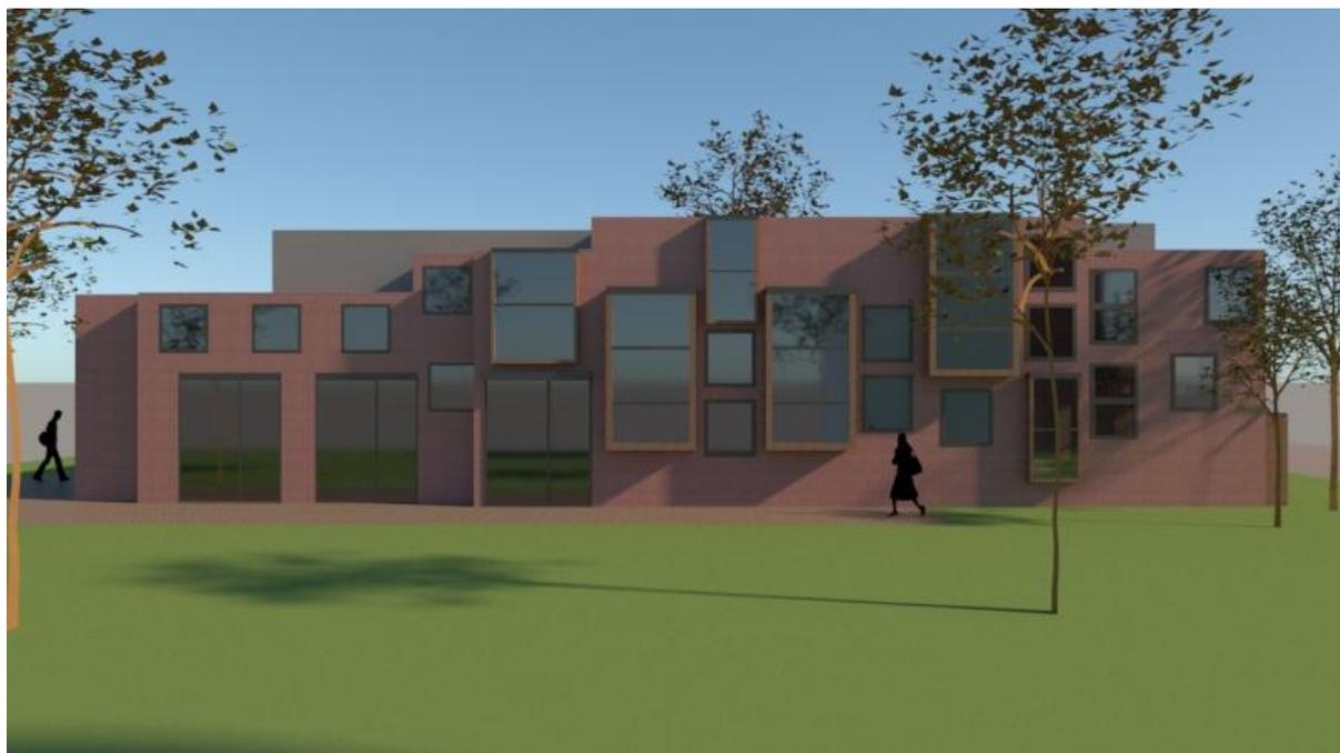
*Figura 21: Elevación lateral del bloque donde se puede observar el uso de grandes ventanales y balcones para el aprovechamiento de la luz natural y ventilación, así como algunos ingresos. Elaboración propia.*
