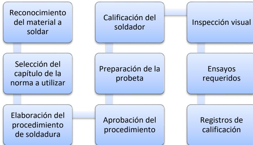
Figura 13. Secuencia que debe seguir para un proceso de mejora de soldadura.
