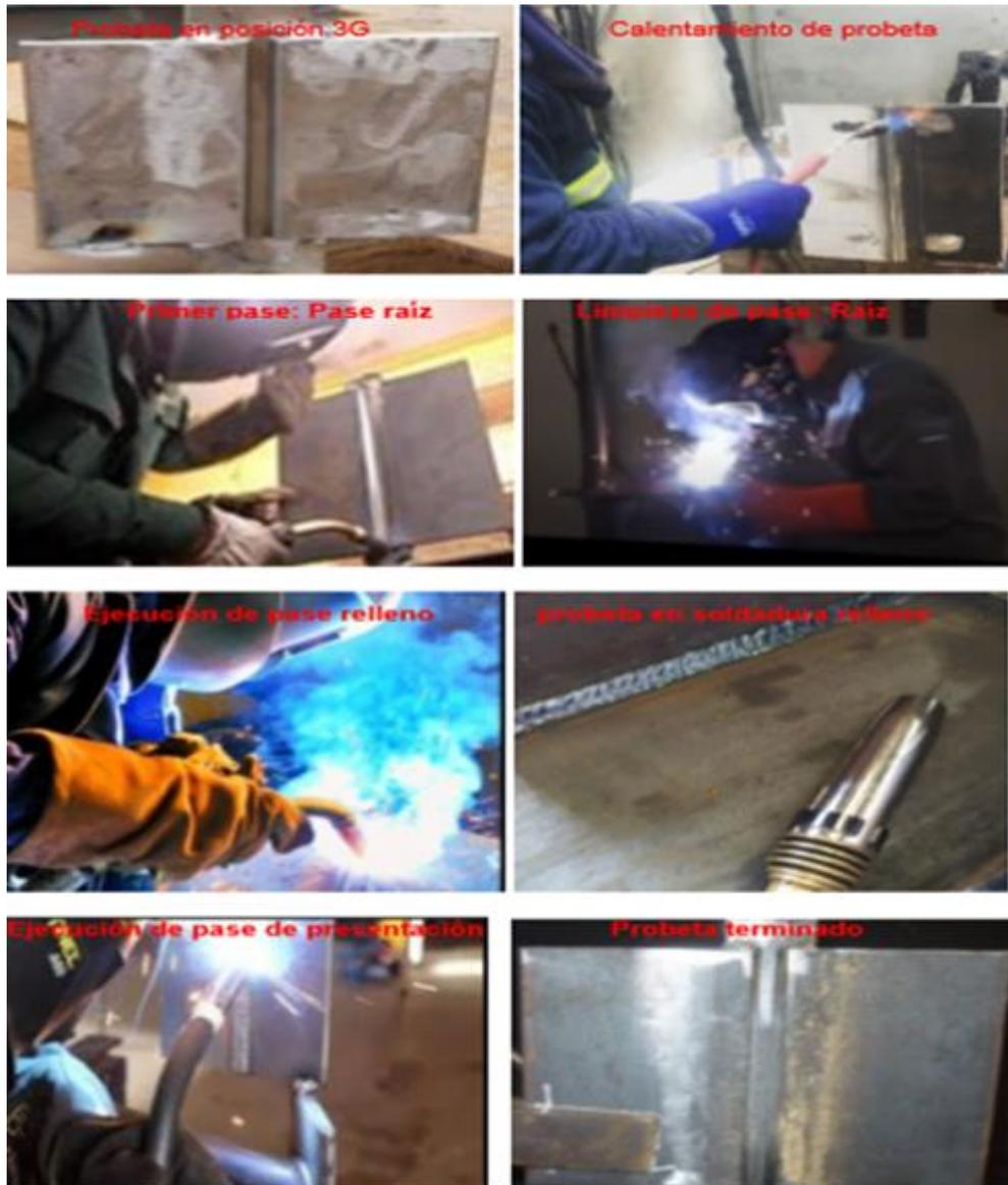
Figura 19. Ejecución de una probeta de soldadura
