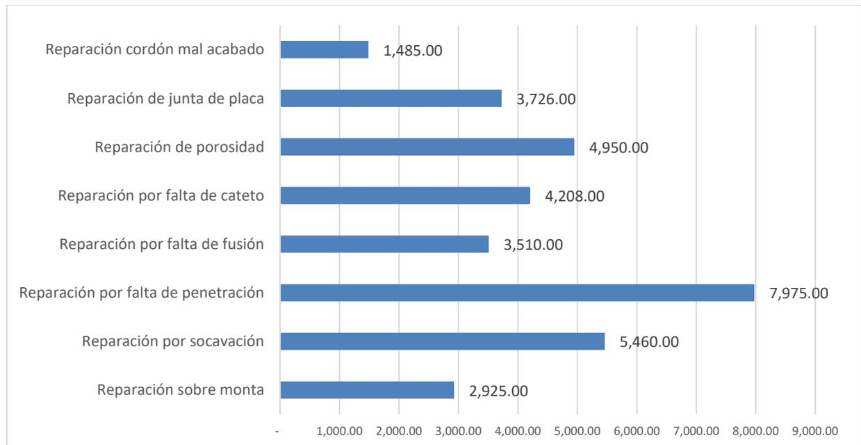
Figura 9. Costo semestral por tipo de reparación de soldadura.
