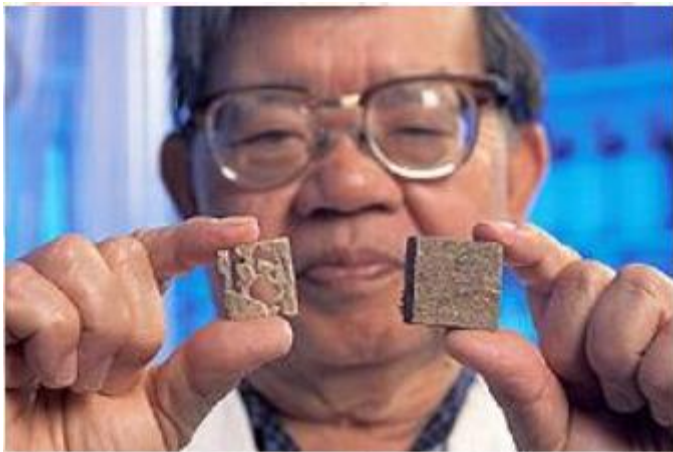
Ilustración 2: Químico Nakayama mostrando probetas de madera de pino (izquierda) y de guayule con HDPE (derecha) expuestas a termitas Fuente: Agriculture Research Service
