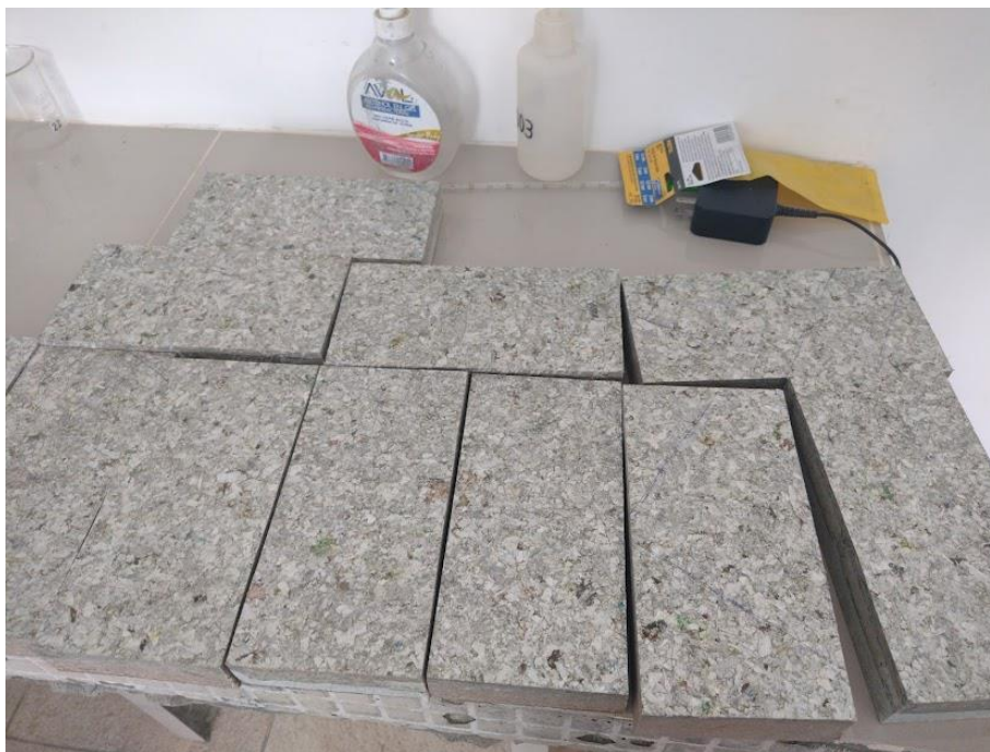
Ilustración 54: Muestras a analizar de la unidad de albañilería a base de Tetrapak reciclado (polialuminio)
