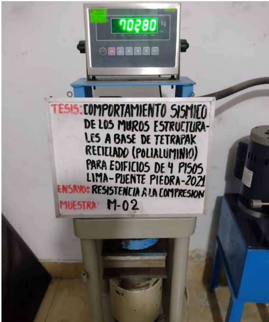
Ilustración 55: Ensayo de compresión de la unidad de albañilería a base de Tetrapak reciclado(polialuminio)
