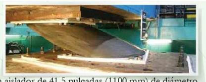
Un aislador de 41.5 pulgadas (1100 mm) de diámetro también fue probado con 47 pulgadas (1200 mm) de desplazamiento de corte. Este soporte fue probado como parte de un programa de investigación para una estructura aislada para toma de una presa.
