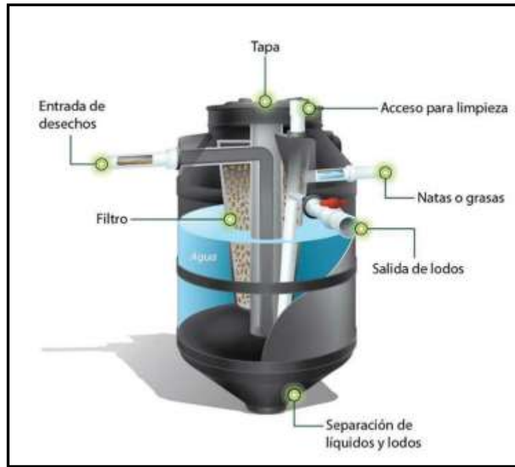
Figura 4. Esquema de tanque séptico mejorado
