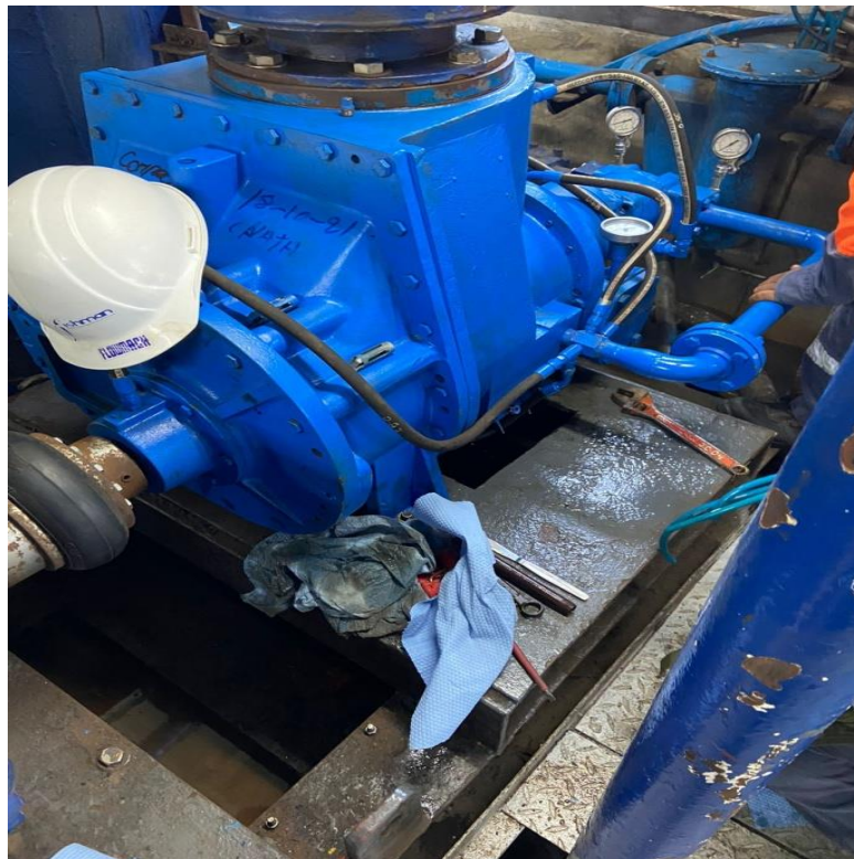
Figura 51 Alineamiento del compresor Leroy, y mantenimiento
