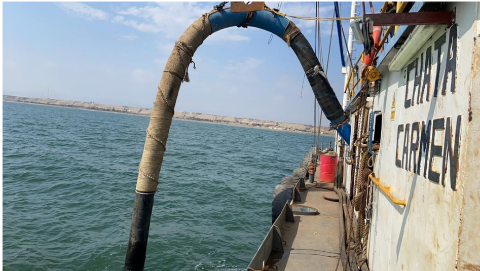
Figura 18 Sistema de succión de pescado
