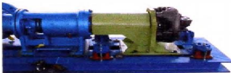
Figura 11 Motor Hidráulico de bomba, 2014 Implementación Preventivo para el sistema de descarga de 100 TN/HR de pescado en chatas absorbentes
