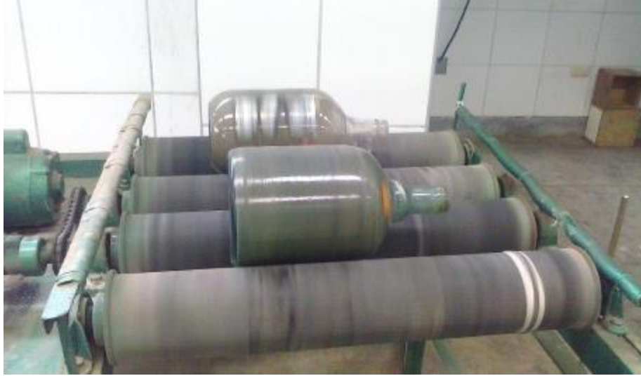
Foto 9. Prueba de lixiviación en botellas agitadas
