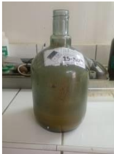
Foto 10. Prueba de lixiviación en botella estática
