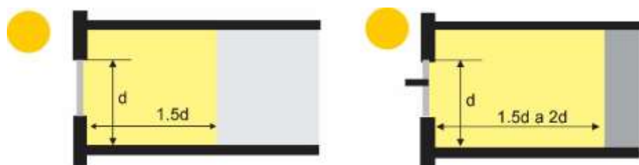
Figura N°5: Profundidad de la iluminación solar
