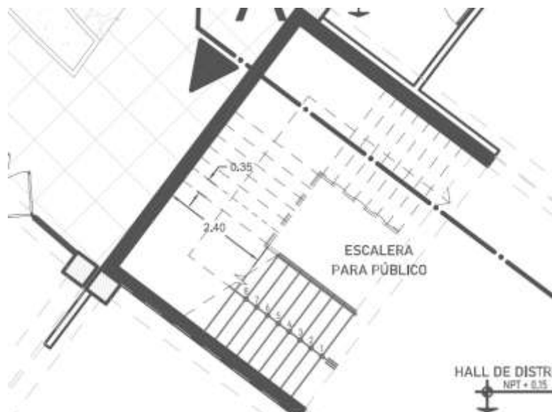
Figura N°131: Medidas de escalera integrada
