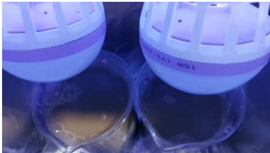
Anexo 10: Muestras con \text{TiO}_2 dentro de la cámara Fotocatalítica
