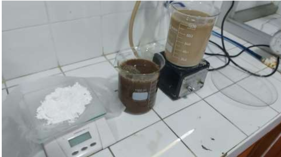
Anexo 09: Mezcla en agitador magnético de \text{TiO}_2 en agua residual en relación de gramo/litro
