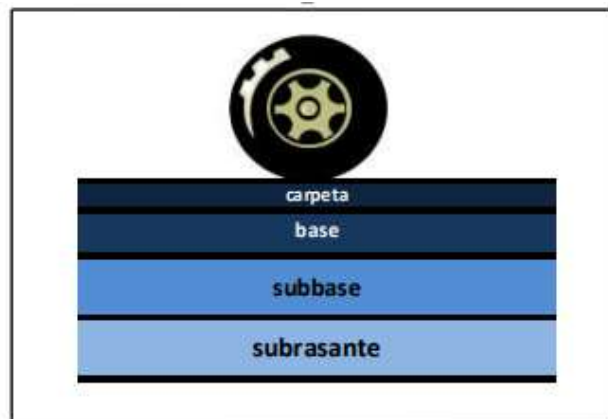
Figura 1. Esquema de paquete estructural de un pavimento
