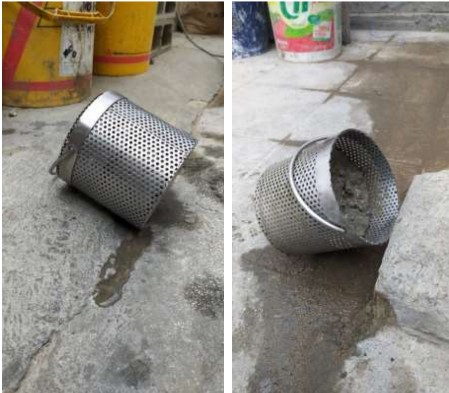
Figura 96 Reposo de la muestra de concreto con una ligera inclinación de la canastilla para que el agua superficial drene
