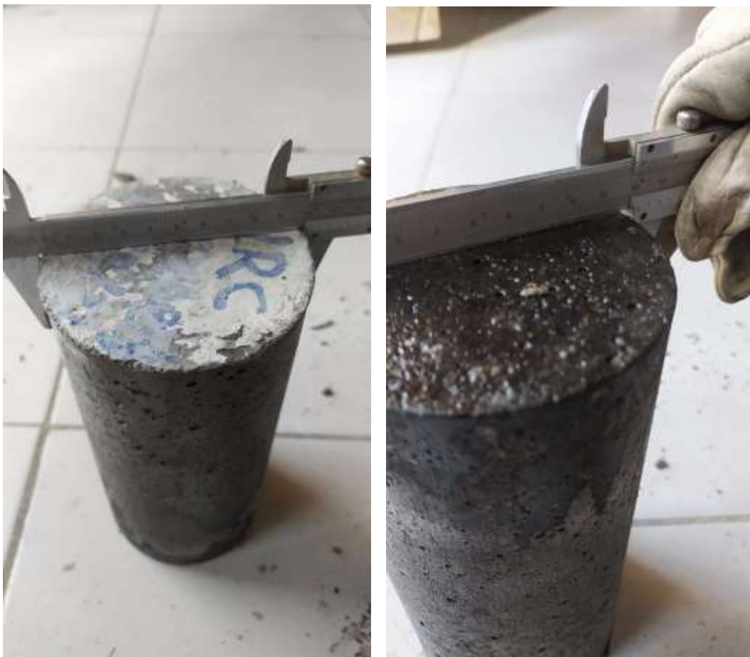
Figura 82 Medición de probetas cilíndricas de concreto
