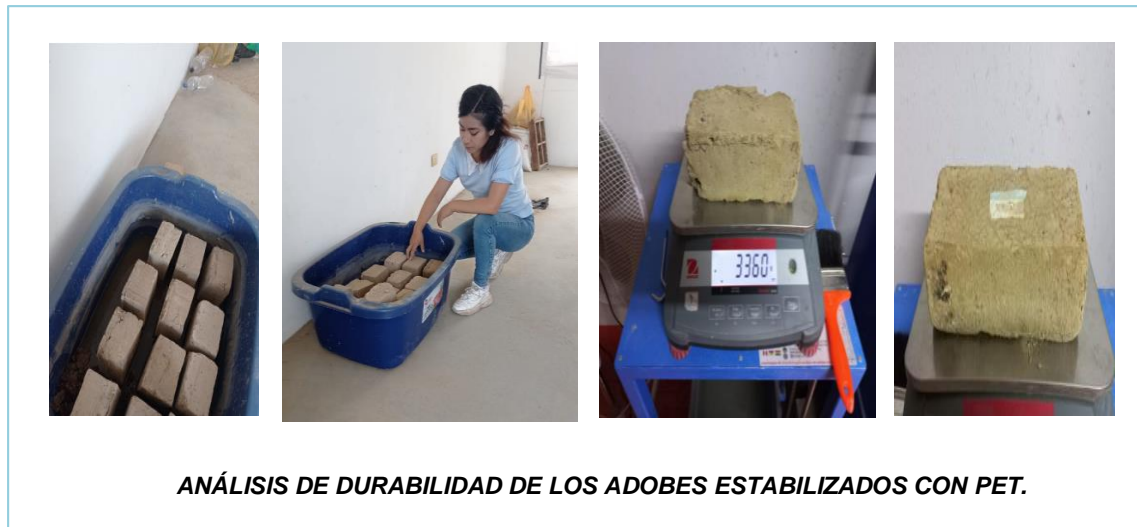
Figura8. Durabilidad de Unidades estabilizadas con PET.
