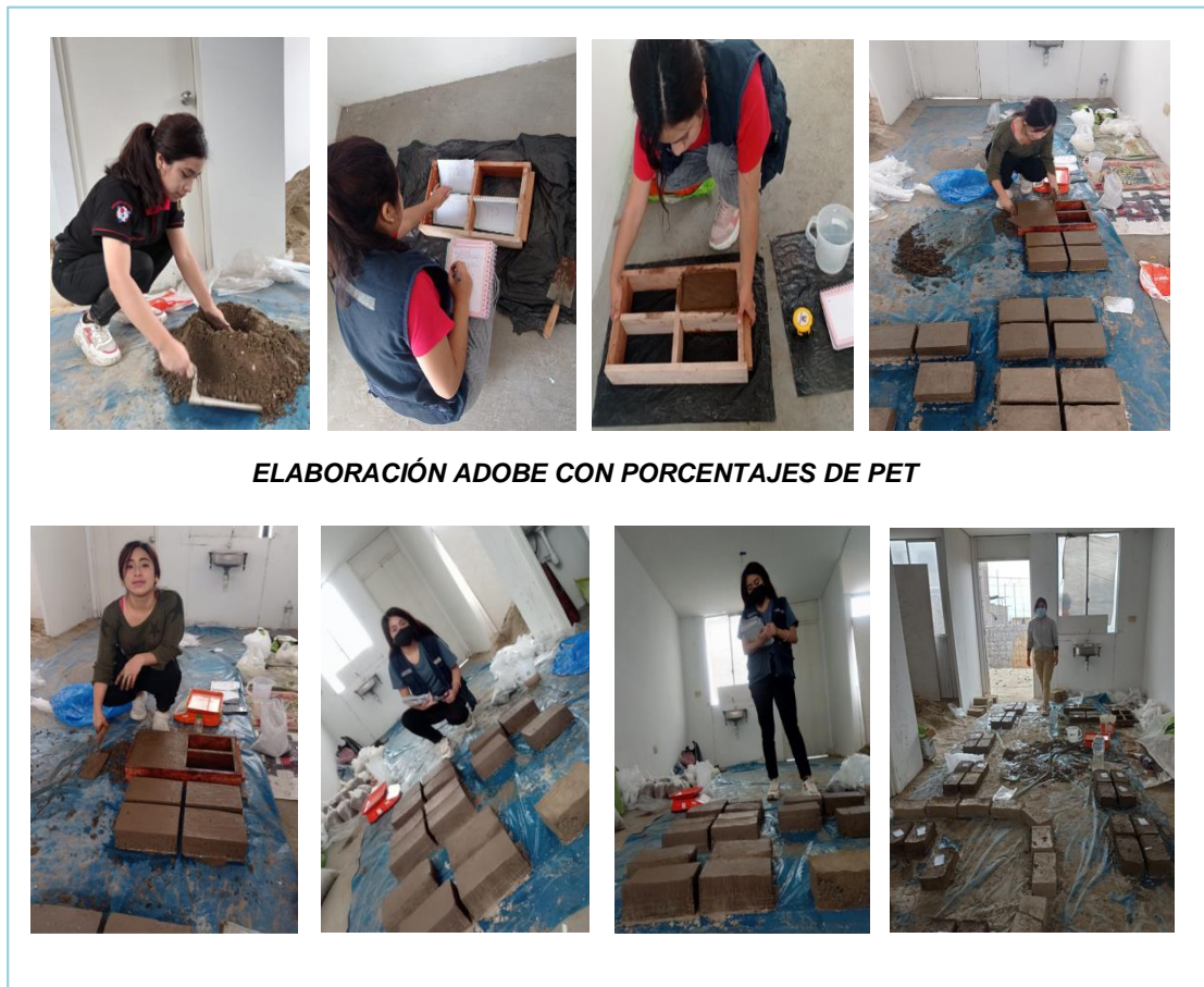
Figura6. Elaboración de Unidades estabilizadas con % de PET en su composición.
