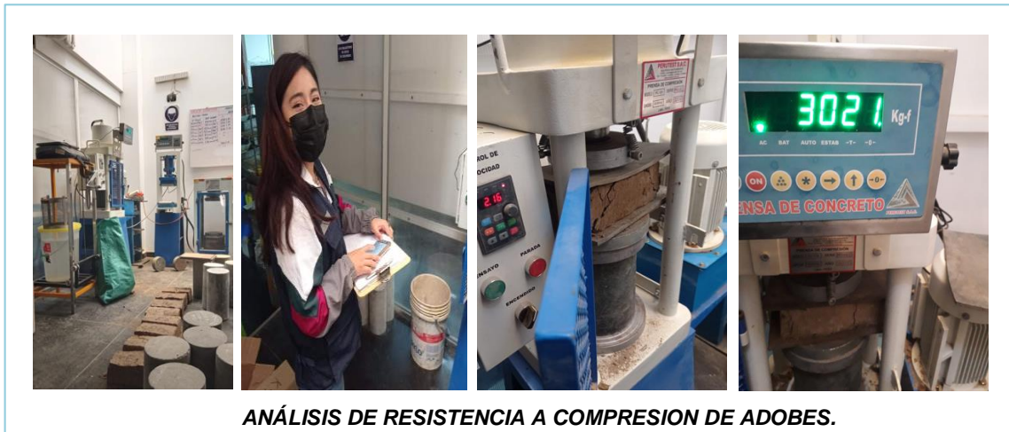
Figura7. Resistencia mecánica de Unidades estabilizadas con PET.
