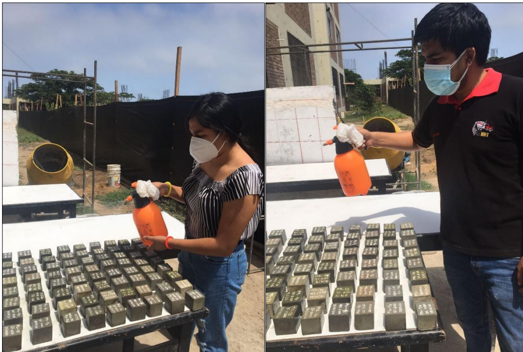
Figura 70. Retiro de las muestras para su secado, pesaje y rotura
