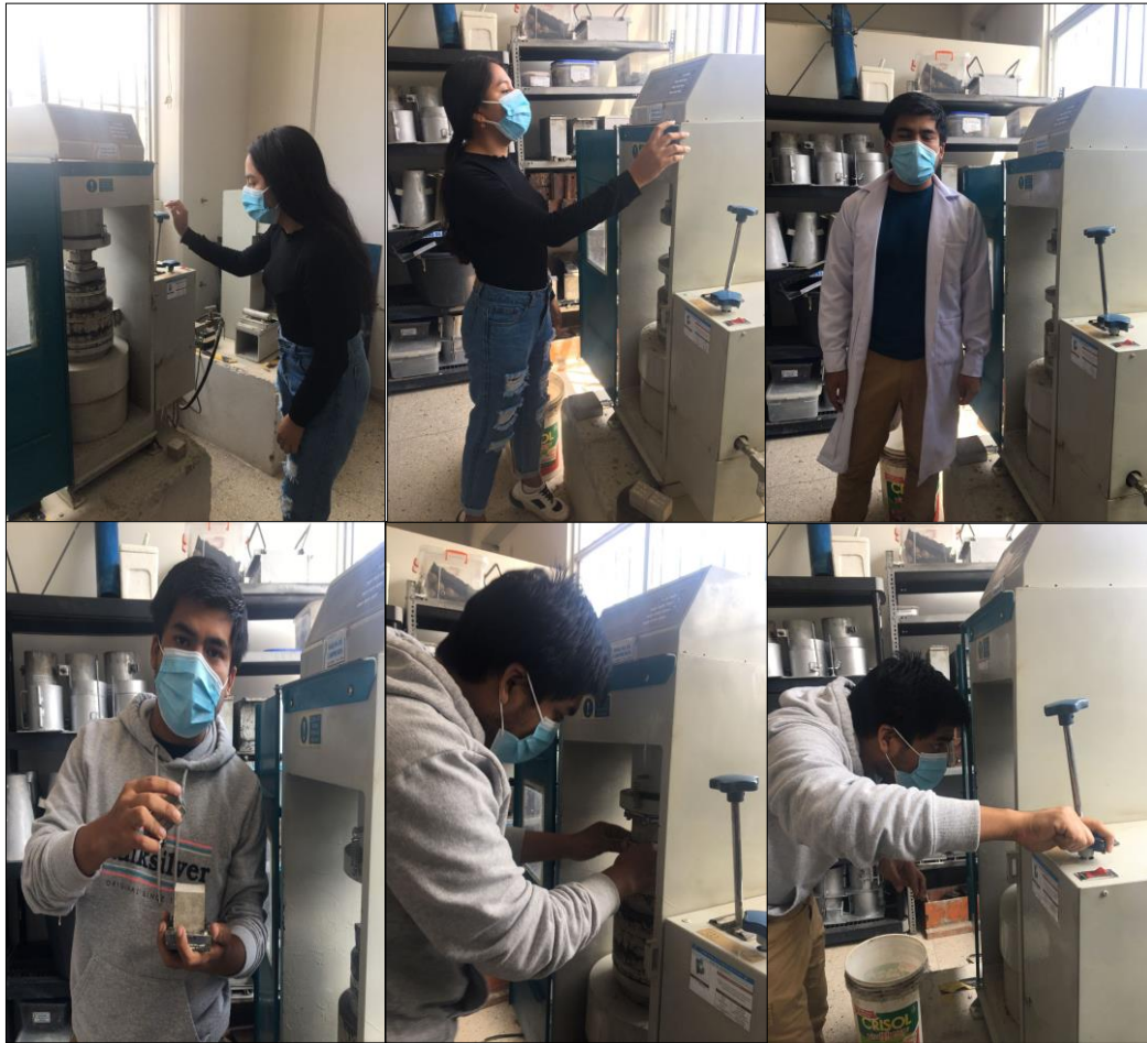
Figura 72. Proceso de rotura de las muestras después del proceso – Laboratorio de concreto reciclado UNT
