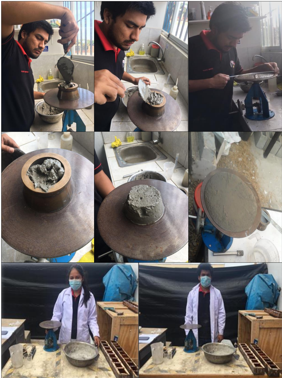
Figura 61. Ensayo de fluidez – Laboratorio de concreto reciclado UNT
