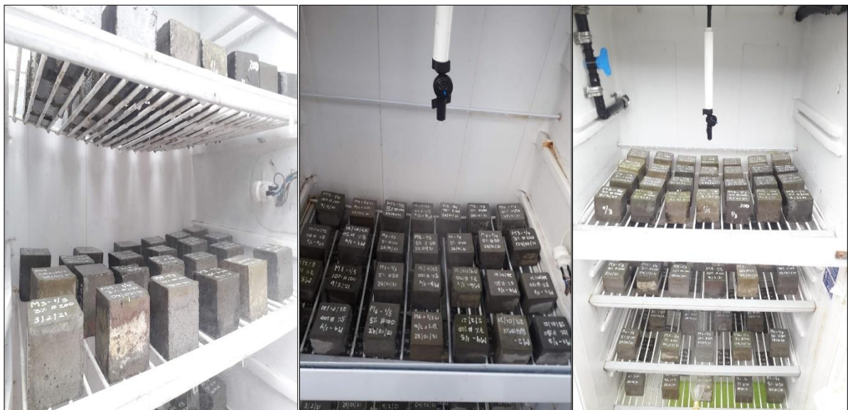
Figura 69. Proceso de degradación en la cámara de humedad
