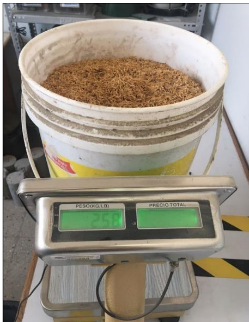
Figura 48. Cascarilla de arroz – Laboratorio de concreto reciclado UNT
