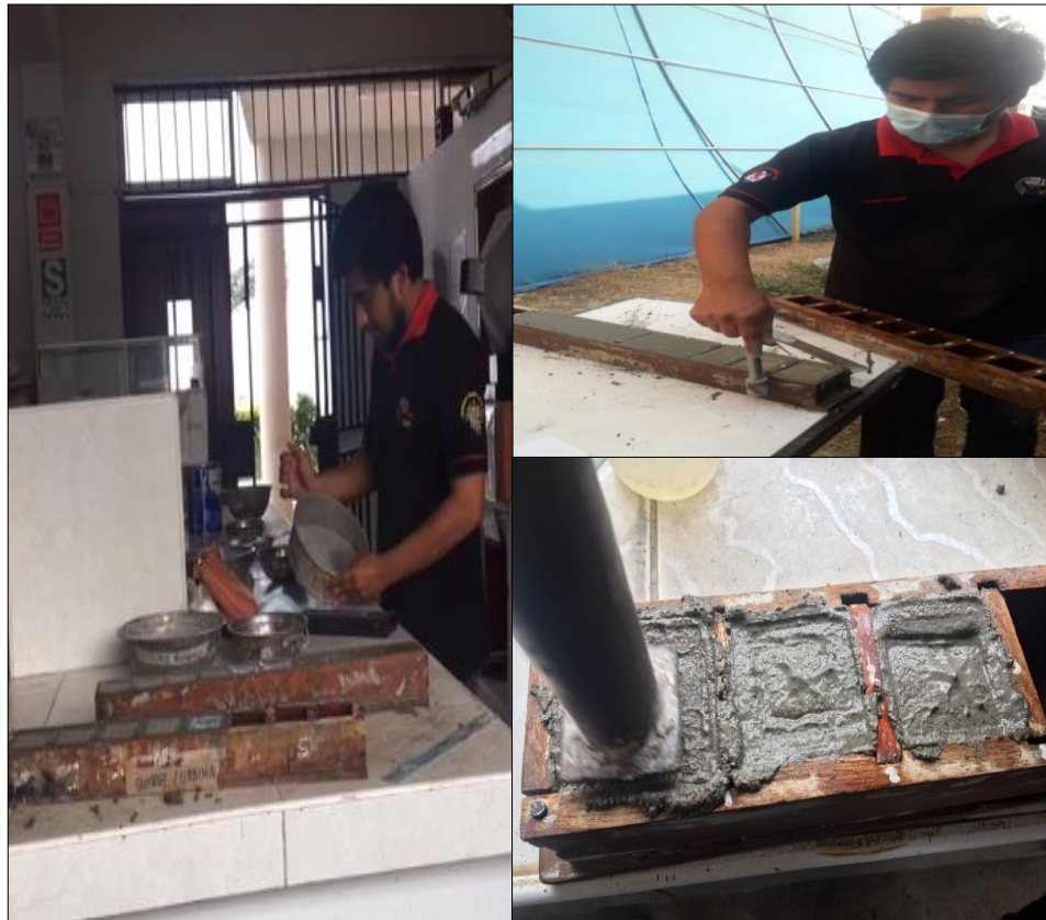
Figura 59. Conformación de los cubos de 5cm x 5cm x 5cm
