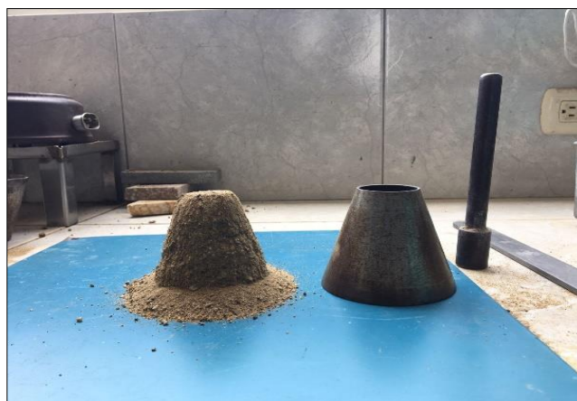
Figura 54. Grado de compactación de la arena – Laboratorio de concreto reciclado UNT
