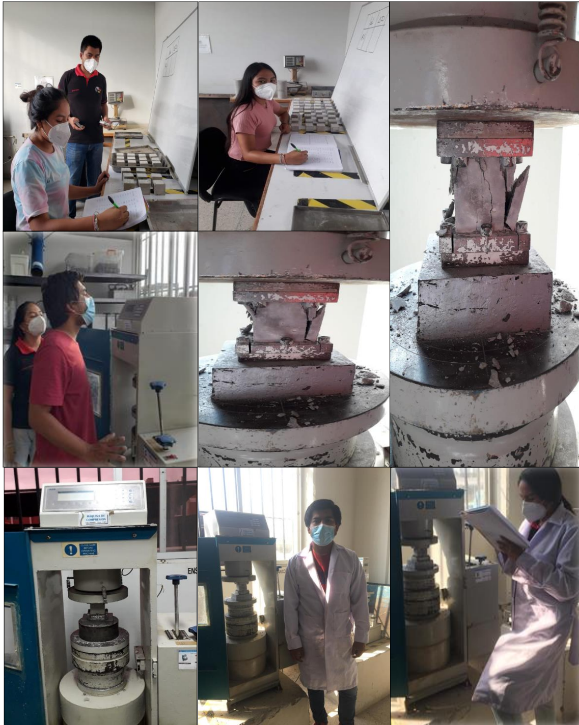
Figura 62. Proceso de rotura de probetas – Laboratorio de concreto reciclado UNT
