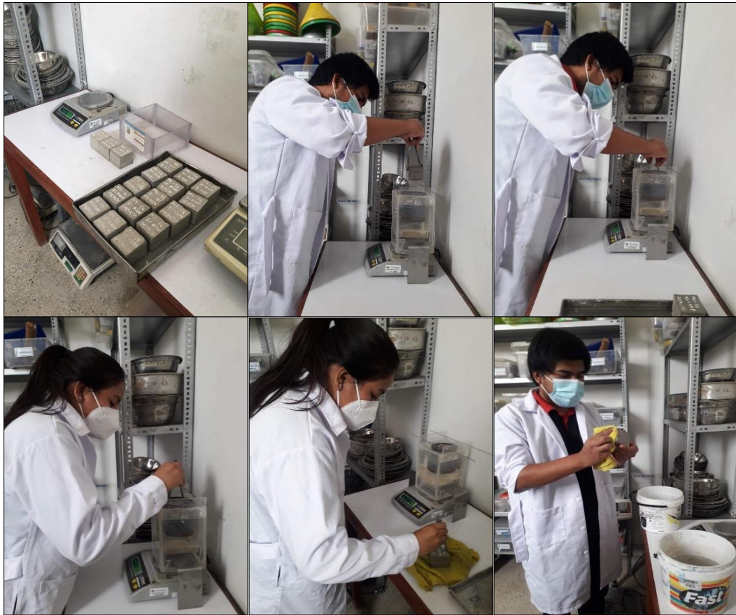
Figura 63. Proceso para obtener el peso suspendido – Laboratorio de concreto reciclado UNT
