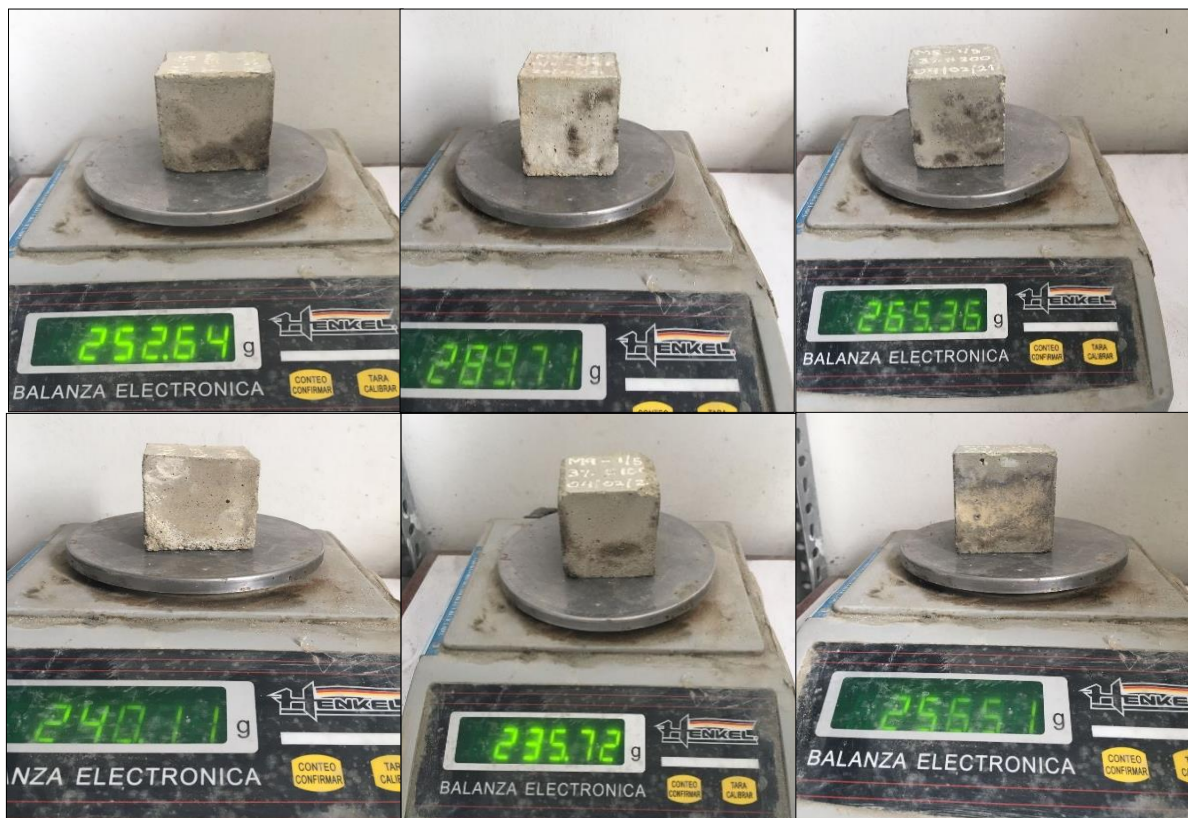
Figura 71. Pesaje en estado seco de las muestras después del proceso
