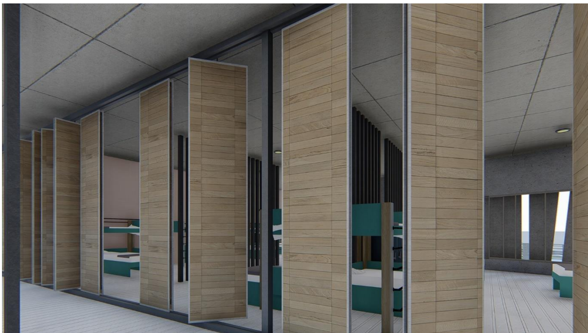
Figura 64 Vista paneles móviles con material liviano en dormitorios
