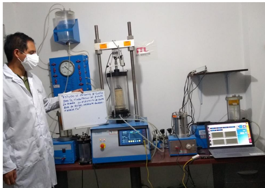
Figura 19. Foto tomada de la Prensa UTEST para ensayo triaxial en el laboratorio MTL Geotecnia.
