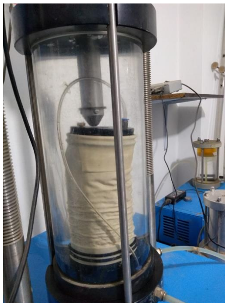
Figura 27. Muestra después de la falla.
