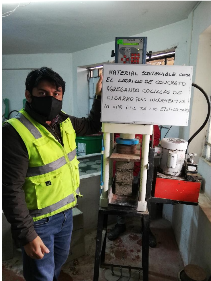
Prueba de resistencia a la compresión de ladrillo en pila
