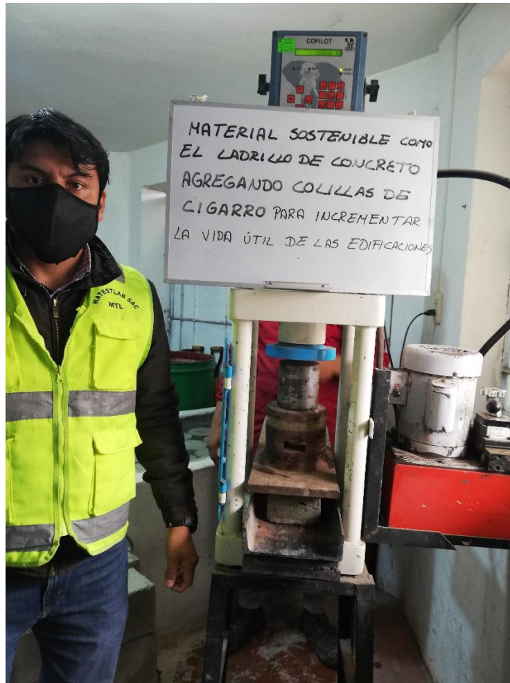
Prueba de resistencia a la compresión de ladrillo individual
