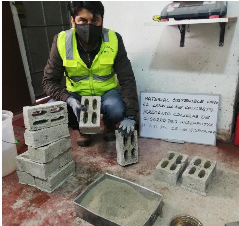
Ladrillos de concreto con colillas de cigarro
