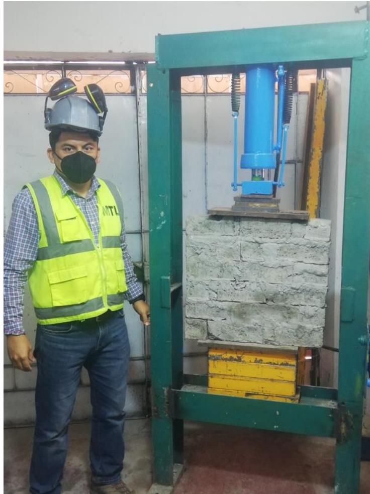
Prueba de resistencia a la compresión de ladrillo en murete
