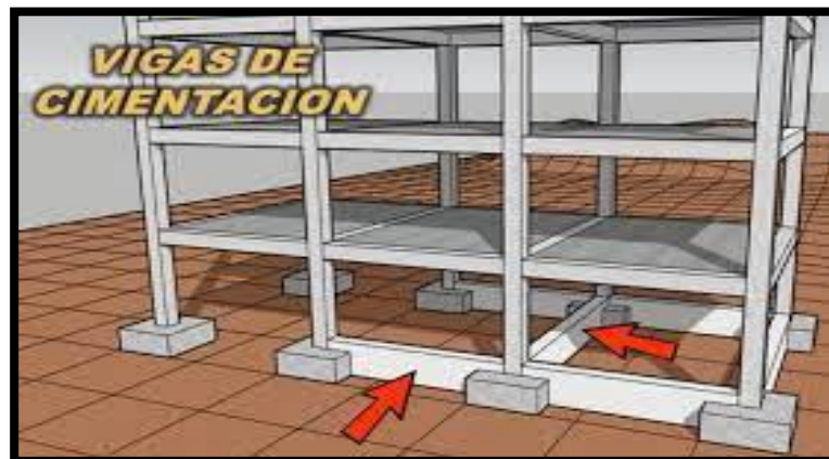
Figura 22 Vigas de cimentación
