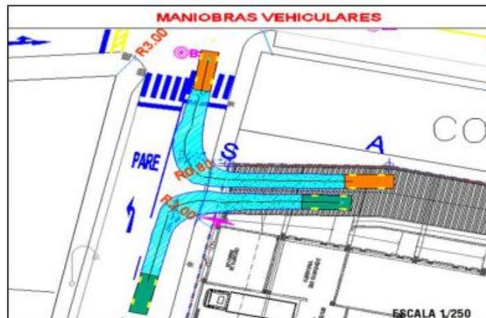
Figura 43: Maniobras vehiculares de ingreso y salida hacia el proyecto. Fuente: Plano de mitigación.
