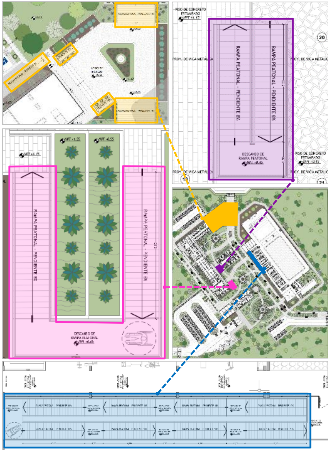
Figura N° 133: Rampa peatonales del CARD de Natación en Trujillo
