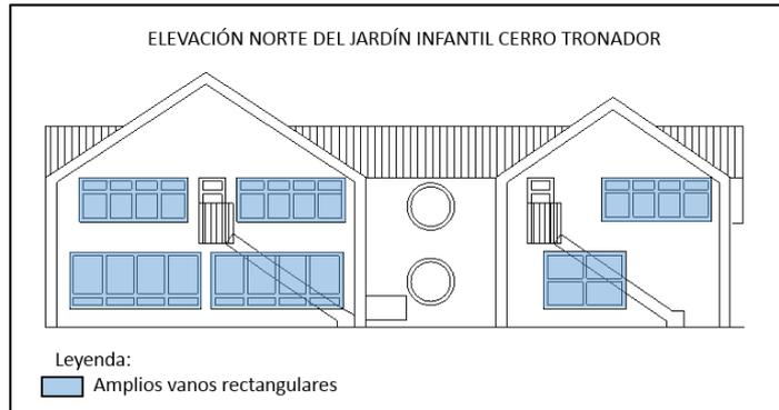
Figura 10. Uso de amplios vanos rectangulares en las aulas para el ingreso adecuado de la luz natural y comunicación con el exterior en el Jardín Infantil Cerro Tronador.
