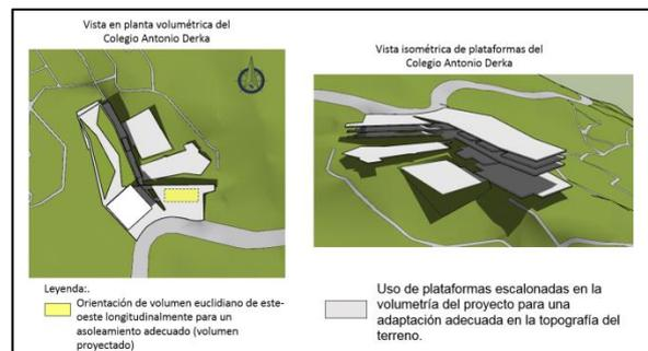
Figura 20. Orientación de volumen euclidiano de este-oeste longitudinalmente para un asoleamiento adecuado en interior de las aulas y uso de plataformas escalonadas en la volumetría del proyecto para una adaptación en la topografía del terreno del Colegio A.D.
