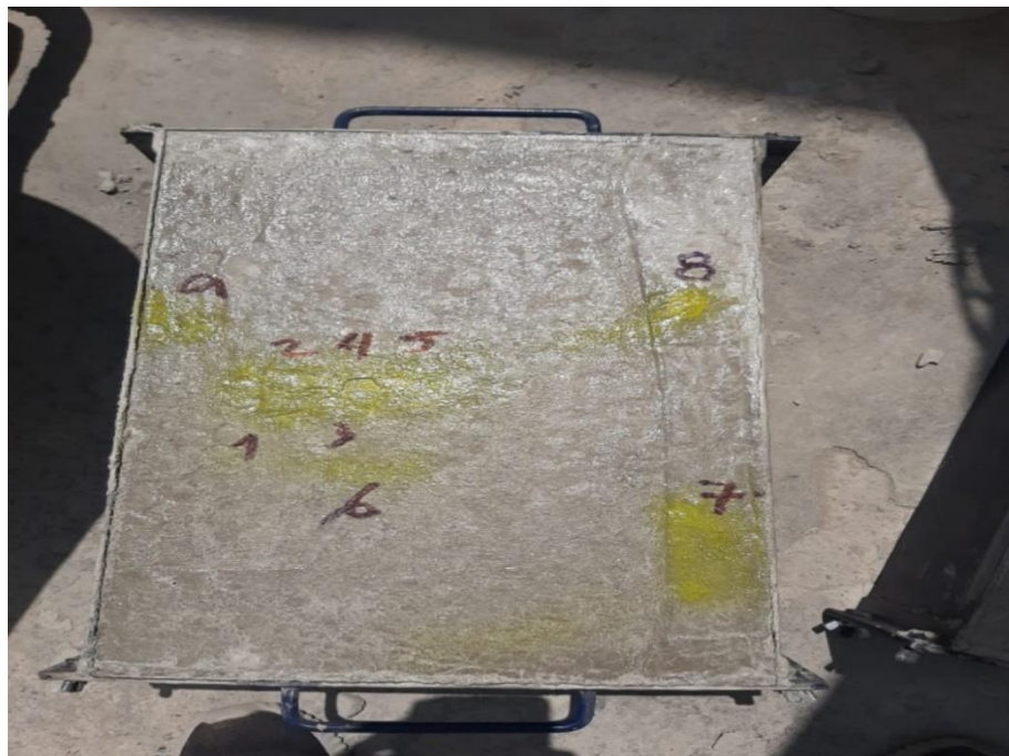
Fotografía 16: Ensayo de fisuración de las probetas rectangulares de concreto con fibras de polipropileno con dosificación de 300 gr/cm 3
