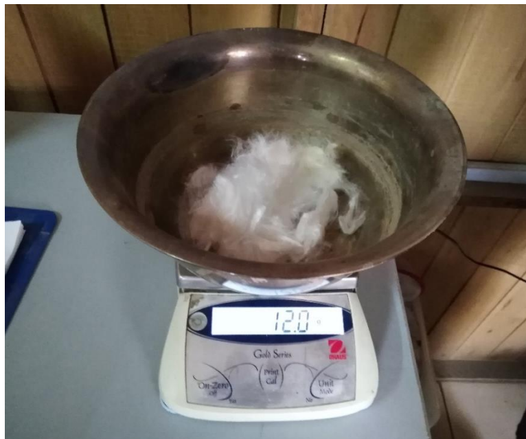
Fotografía 4: Pesaje de fibras de polipropileno
