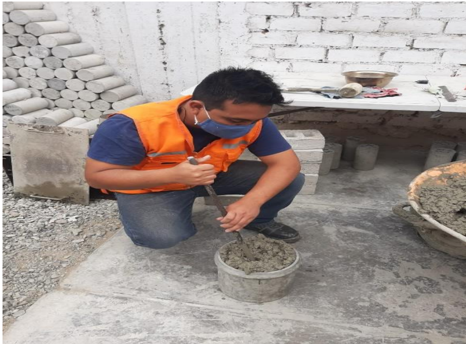
Fotografía 9: Compactación del concreto fresco con fibras de polipropileno con dosificación de 300 \text{ gr/cm}^3 .
