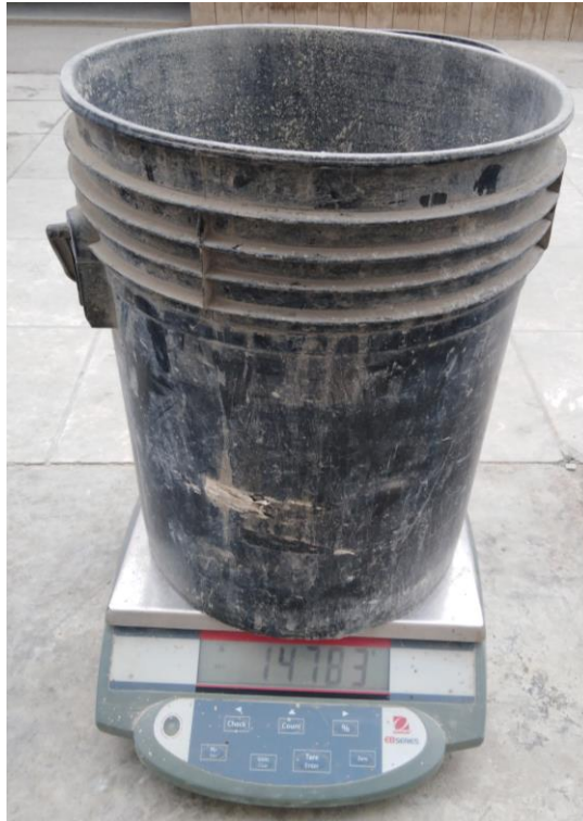
Fotografía 3: Pesaje de cemento
