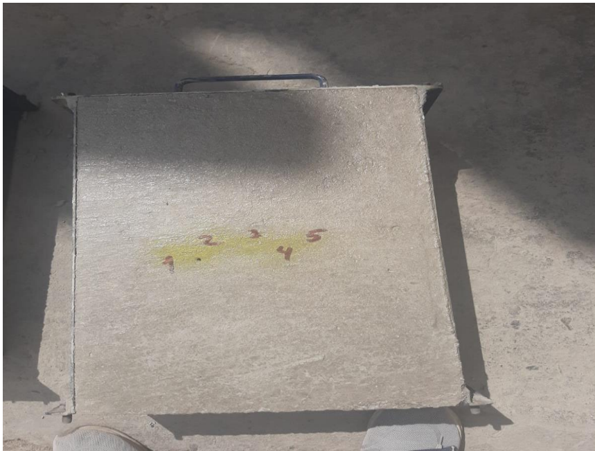
Fotografía 17: Ensayo de fisuración de las probetas rectangulares de concreto con fibras de polipropileno con dosificación de 600 \text{ gr/cm}^3
