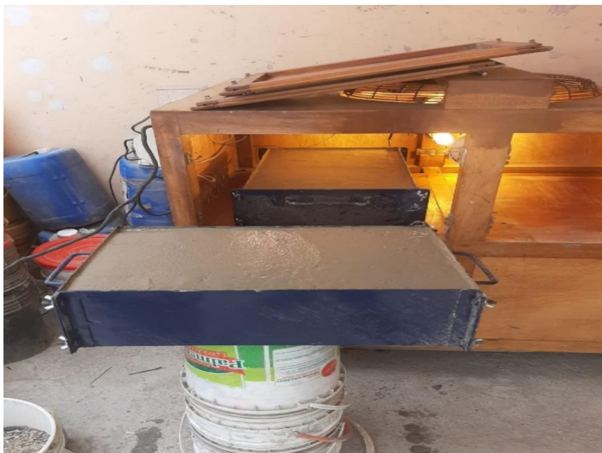
Fotografía 14: Probetas rectangulares siendo ingresadas a la cámara de fisuración para ser sometidas a los ensayos de fisuración.
