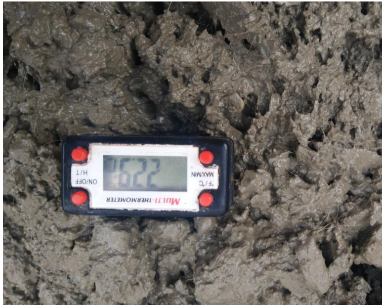
Fotografía 5: Temperatura del concreto fresco con fibras de polipropileno con dosificación de 300 \text{ gr/cm}^3 .
