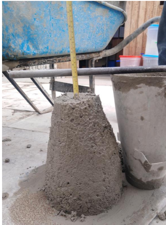
Fotografía 7: Asentamiento del concreto fresco con fibras de polipropileno con dosificación de 300 \text{ gr/cm}^3 .
