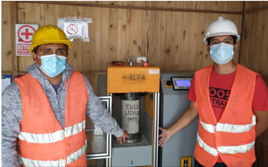
Fotografía 11: Rotura de testigo de concreto con fibras de polipropileno con dosificación de 900 gr/cm 3 a la edad de 28 días.
