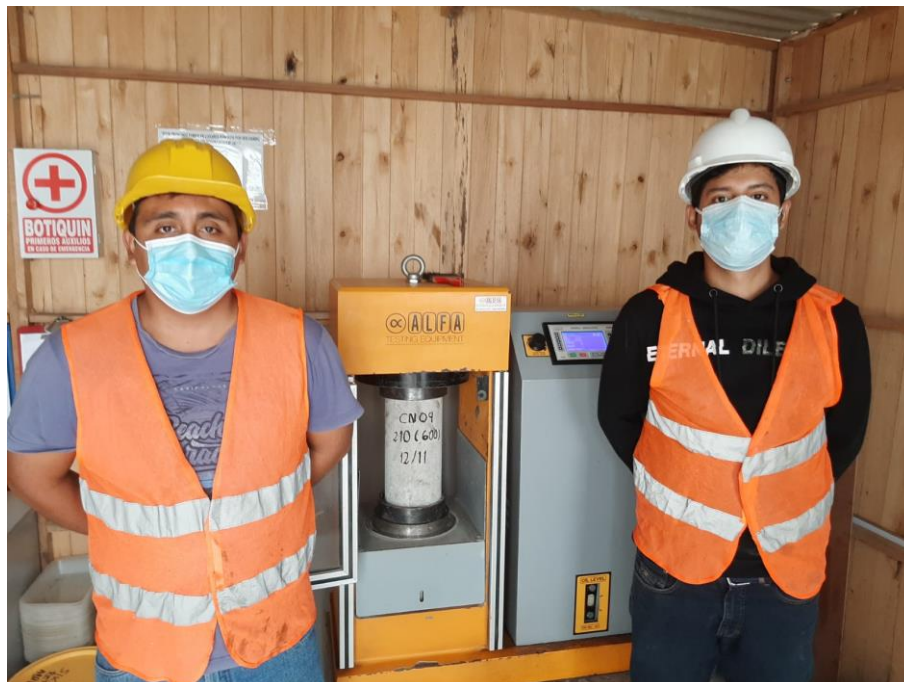
Fotografía 12: Rotura de testigo de concreto con fibras de polipropileno con dosificación de 600 gr/cm 3 a la edad de 28 días.
