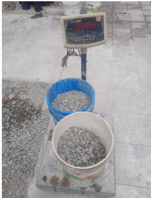
Fotografía 1: Peso unitario compactado del agregado grueso
