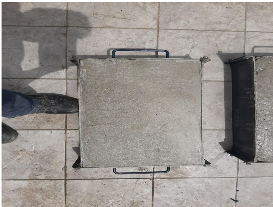
Fotografía 18: Ensayo de fisuración de las probetas rectangulares de concreto con fibras de polipropileno con dosificación de 900 \text{ gr/cm}^3
