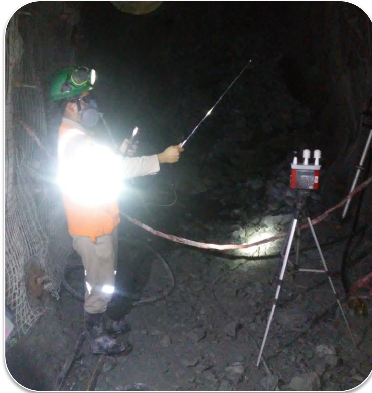
Se observa monitoreo de velocidad de aire en labor minera.
