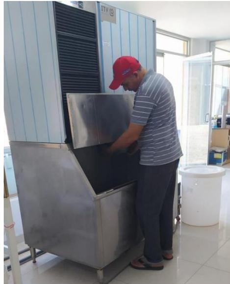
De esta manera y en esta posición es en la que el operario recepciona el hielo de la máquina 3, la cual, por su diseño y gran altura desde la boquilla hasta la base, provoca que el hielo caiga de gran altura y se rompa, perdiendo su diseño, por lo que el operario opta por amortiguar la caída recepcionando el hielo en un recipiente de plástico. A diferencia de las otras dos máquinas, ésta es en la que más merma representa a la empresa.
