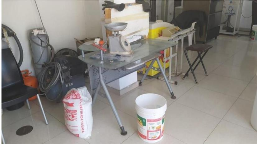
La altura de la mesa de trabajo es de aproximadamente 0.7 m, lo que provoca el encorvamiento del operario como se aprecia en el anexo 1, la balanza es de tipo de cocina, con aguja imprecisa y la selladora es de diseño y modelo antiguo, demora en sellar 6 segundos.
