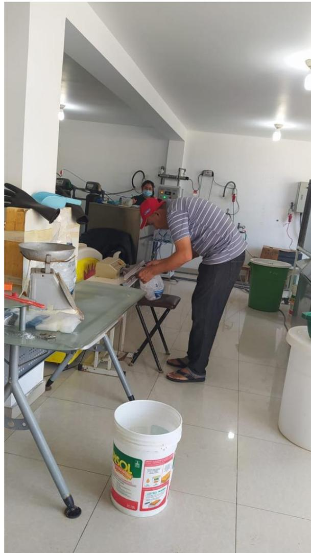
Se puede observar la posición de encorvamiento que presenta el operario al momento del sellado, aparato que se encuentra a un costado de la mesa de trabajo, ambos elementos de muy baja altura para el operario.
