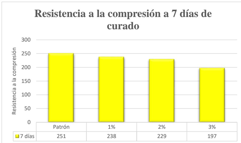
**Figura 5:** Resistencia a la compresión promedio a 7 días de curado
