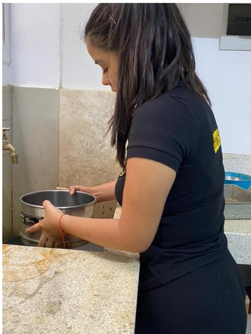
Anexo N° 50 – Ensayo de Contenido de Humedad
