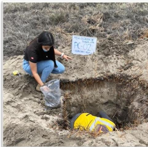
Figura 14 - Extracción de muestra del PC-02
