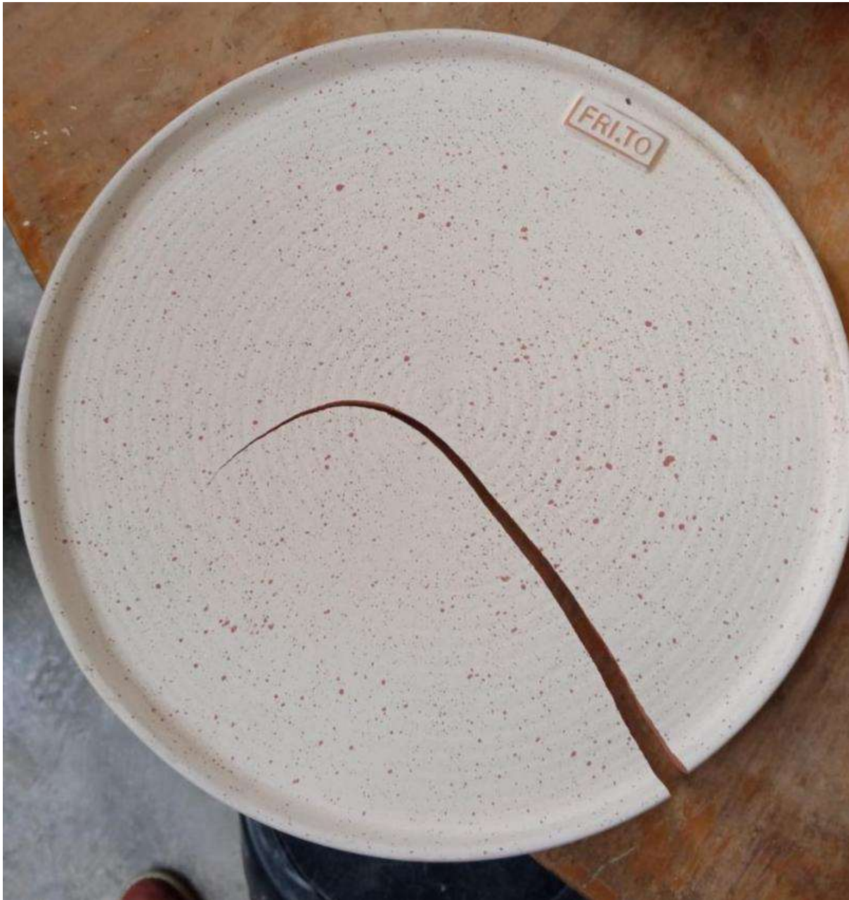
Figura 10. Plato con falla a causa de horno
