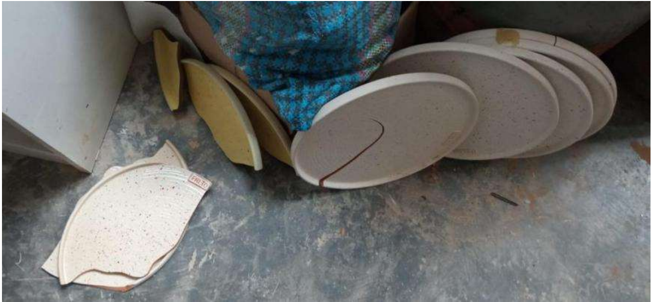
Figura 8. Piezas con fallas (platos)
