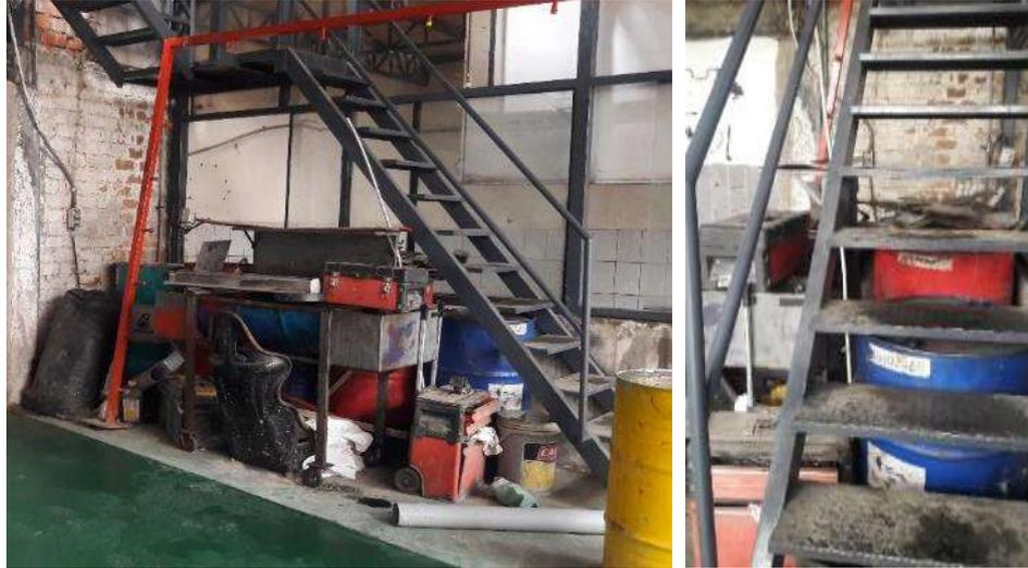
En la imagen N° 8 se aprecia los excedentes sólidos y líquidos que no van a ser reutilizados no se encuentran almacenados de manera adecuada para su posterior disposición final hacia las empresas o personas encargadas del recojo de desechos industriales. Siendo así puntos altamente peligrosos para la salud y seguridad de los colaboradores de la empresa CMD.
