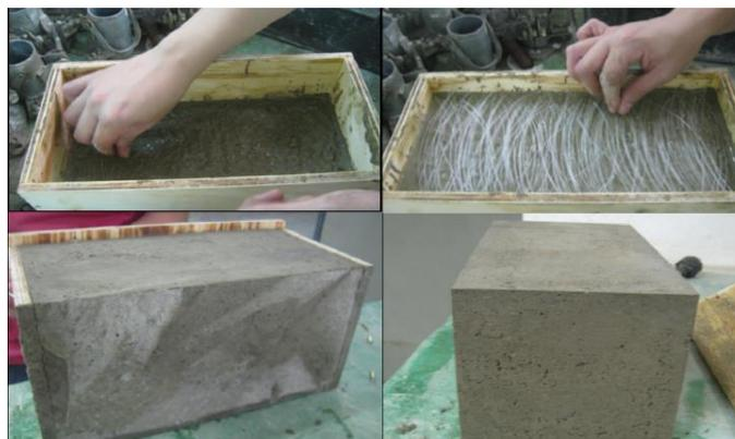
Fig. 3 Concreto con fibra óptica colocado por capas y desencofrado [7].
