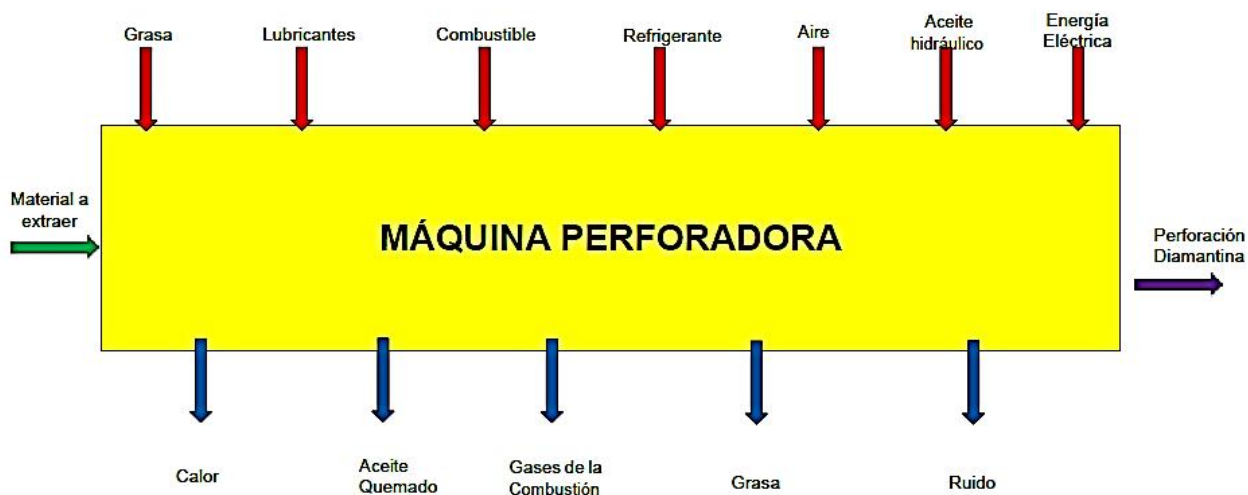
Figura 3. Variables que intervienen en los sistemas de las máquinas perforadoras.
